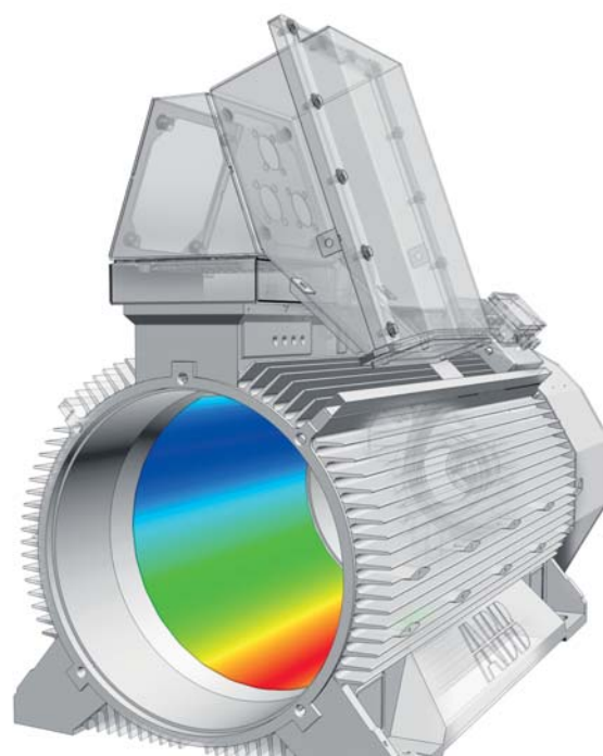
Modelování rotační elektromagnetické síly umožňuje předvídat mechanické vibrace (štít a rotor jsou pro větší názornost odstraněny).
