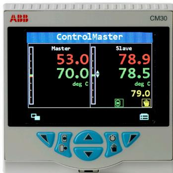
Abbildung 2 Anzeige der Kaskadenregelung
