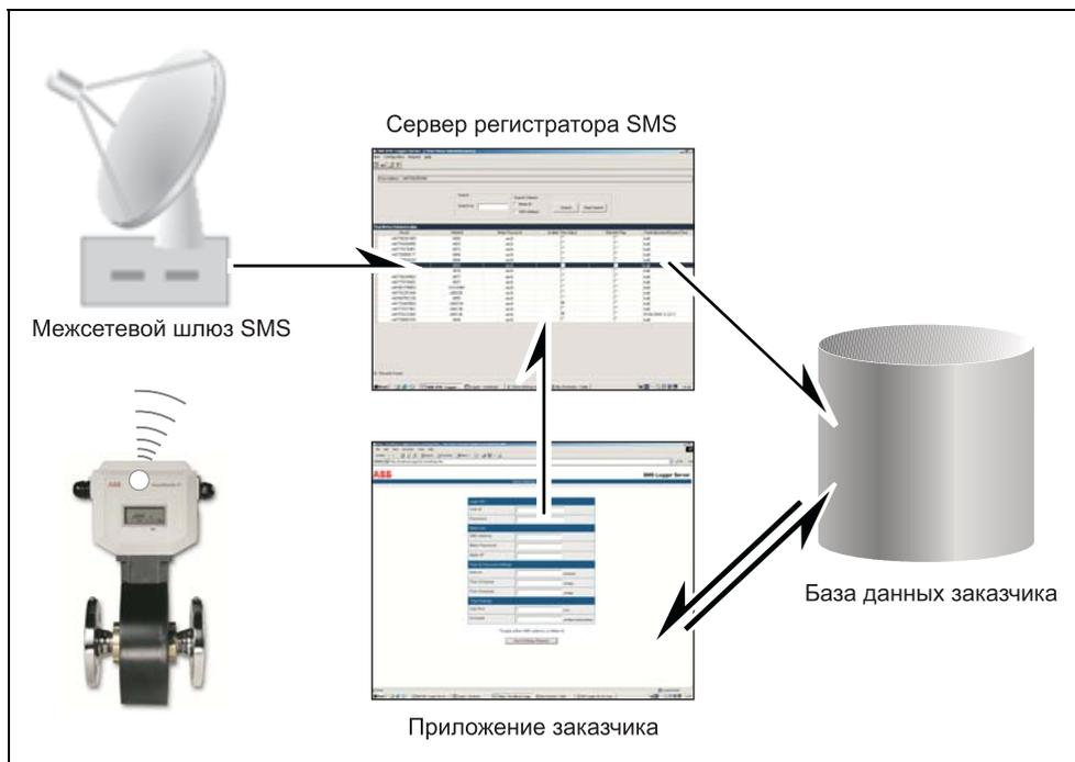
Рис. 7.1 Межсетевой шлюз SMS – Обзор
