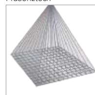
4 сенсорных датчика и система зеркал и линз сигнализатора присутствия Busch-Wächter® Präsenzttech
