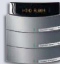
KNX-сенсор Busch-triton®, 3-канальный управляющий элемент с подсветкой поля для маркировки, ЖК-дисплеем и ИК-приемником
