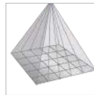
4 сенсорных датчика и система зеркал и линз сигнализатора присутствия Busch-Wächter® Präsenzttech
