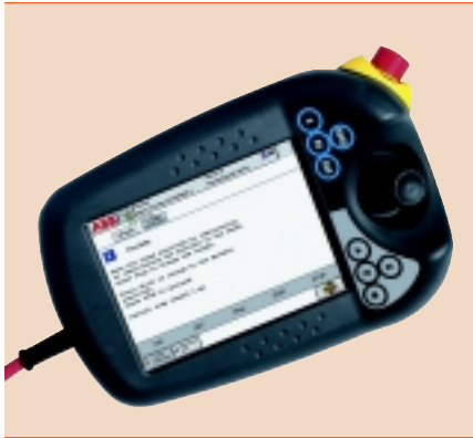
3 处于“修改焊接处”模式的 FlexPendant。
