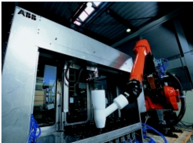
■ 喷涂机器人更换操作机内的涂料盒，空涂料盒自动被充满。
