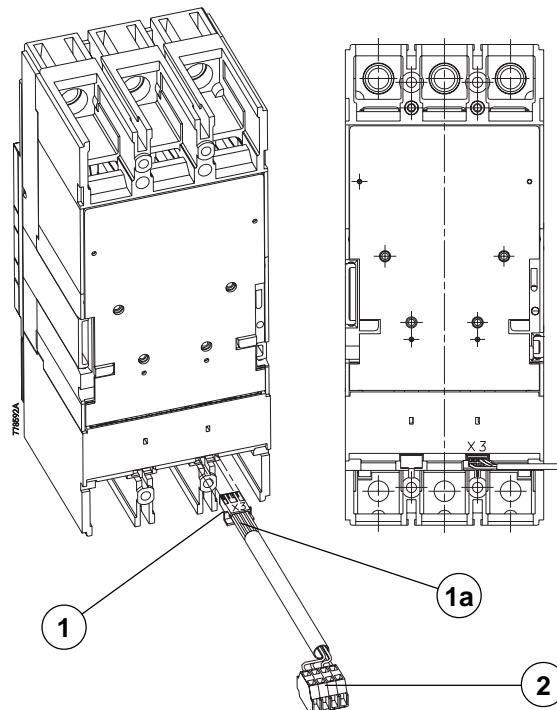
Inserire il connettore (1) nell'apposita sede della parte posteriore dell'interruttore. Disporre i fili (1a) nella cava prevista quindi fissare l'interruttore al supporto. Con riferimento allo schema elettrico allegato all'interruttore, eseguire i collegamenti del circuito esterno mediante la morsettiera (2).
