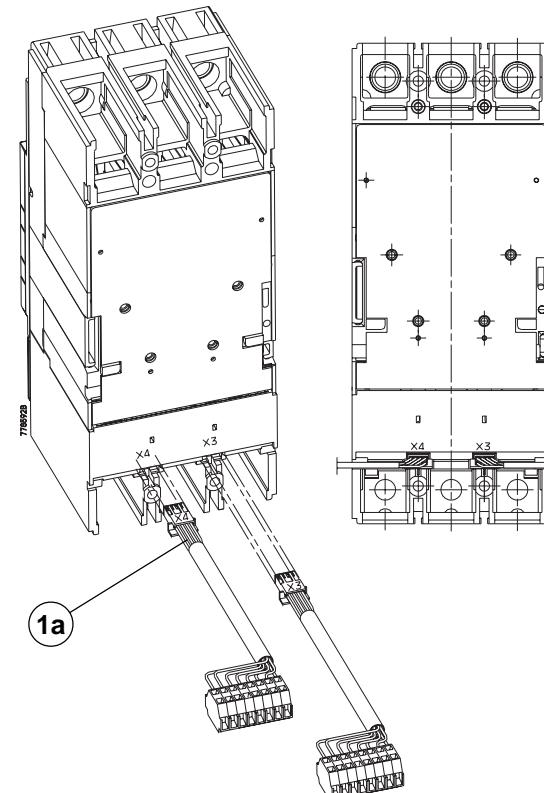
Introduire le connecteur (1) dans le logement de la partie postérieure du disjoncteur. Ranger les fils (1a) dans le perçage prévu, donc fixer le disjoncteur au support. En se référant au schéma électrique joint au disjoncteur, effectuer les connexions du circuit extérieur à l'aide du bornier (2).
