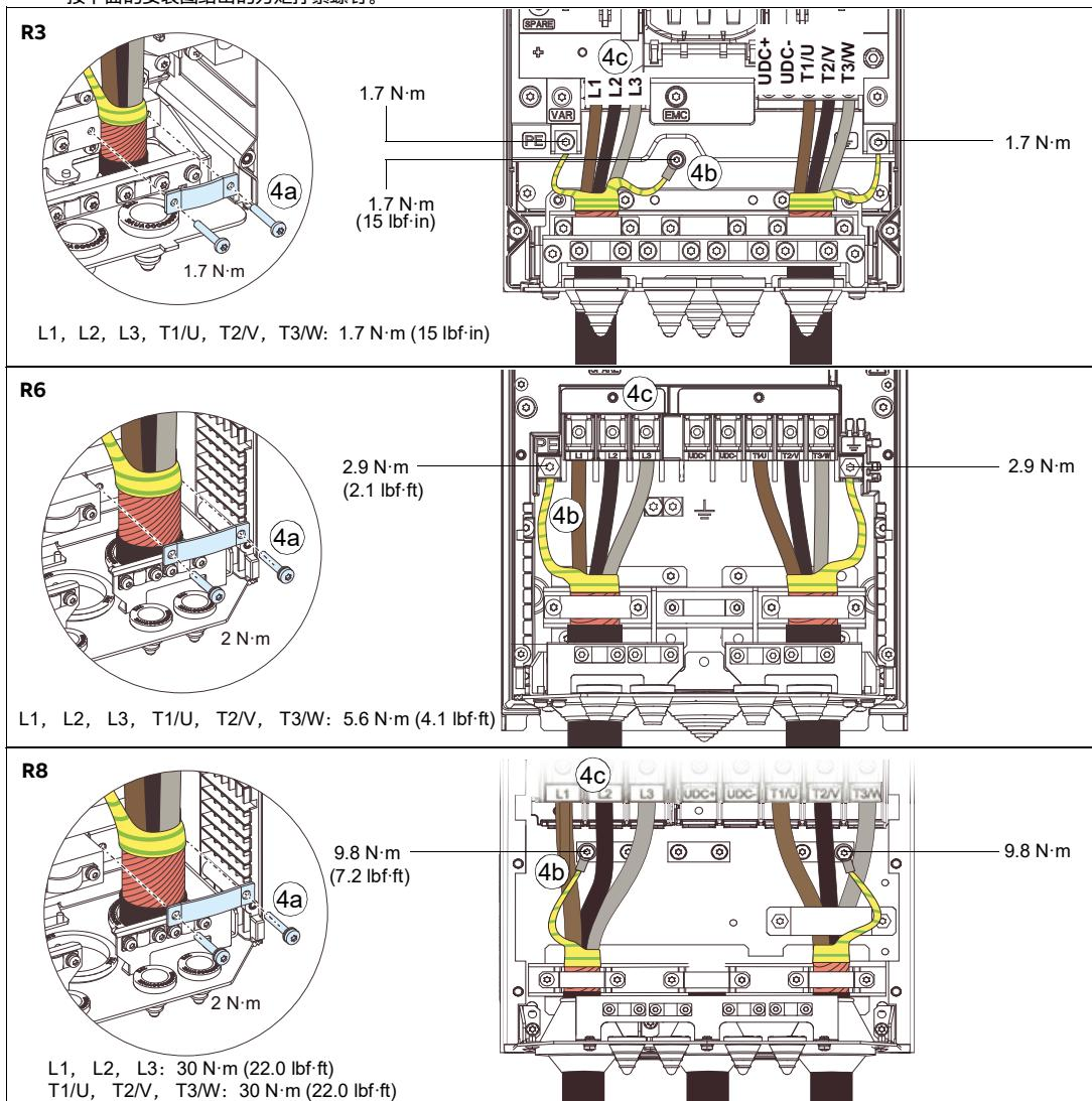
5. 外形 R8: 如果已在第 2 步将侧板拆下，则将其装回。以机械方式将电缆固定在变频器外。
