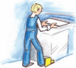
La **pédale à trois positions** est utilisée pour plus de sécurité quand l'opérateur doit tenir la pièce de travail des deux mains pendant le fonctionnement.
