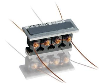
Der in einer Folienmessrolle verwendete 52 mm breite Sensor.
