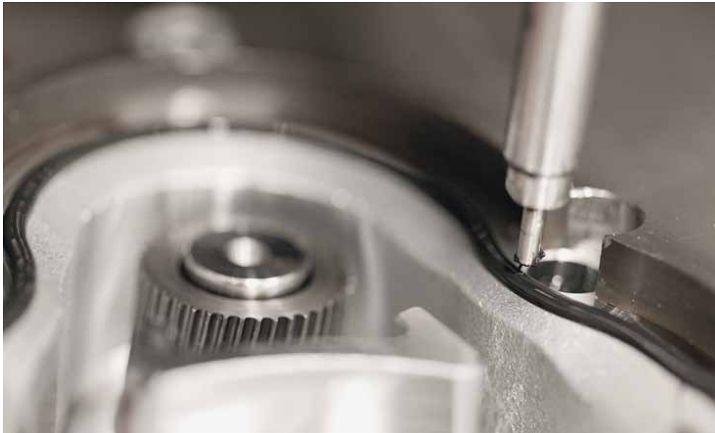
Die Lenksystemdichtung ist fast fertig: Gefertigt wird sie vom Roboter IRB 140, einem integrierten Dispenser.
