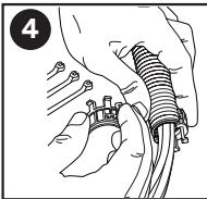
**Étape 4:** Clipser la première moitié de la bague de décharge de traction BCSR sur la gaine terminale (à savoir le premier creux du gainé annelée). Positionner la seconde moitié sur la première, en appuyant solidement jusqu'à entendre un «clic» sur les deux côtés.
