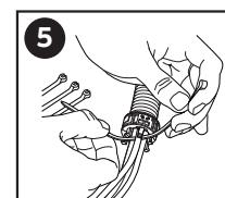
**Étape 5:** Pour une décharge de traction sur les câbles et les tubes, les installer individuellement sur les «dents» de la bague de décharge de traction BCSR en utilisant des colliers de serrage TyRap®.
