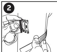
**Étape 2:** Utiliser l'autre côté du Velcro™ pour retenir solidement le support BCCH autour du bras Cobot.
