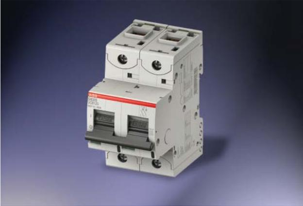
Para los interruptores automáticos de la serie S800S UC, las curvas características disponibles son B y K y ambos tipos poseen corrientes nominales de hasta 125 A y una capacidad de corte de 50 kA.
