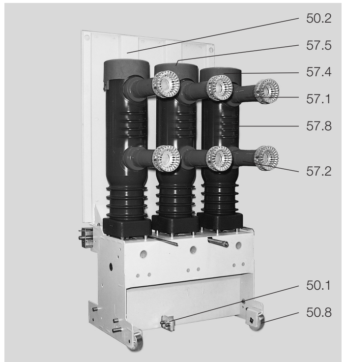
Fig. 3/8: Disjuntor a vácuo VD4 com partes dos polos montadas e ventilação forçada (ventilador), versão extraível, lado dos polos 2500 A para utilizações a 55 °C - 3150 A, 25/31,5 kA para utilizações a 40 °C
