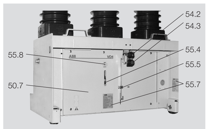
Fig. 3/4: Elementos de indicação e comando do disjuntor fixo 50.7 Painel frontal 54.2 Botão mecânico ON 54.3 Botão mecânico OFF 55.4 Indicador mecânico da posição de manobra 55.5 Contador de operações mecânico 55.6 Sede de engate (para alavanca de carregamento) 55.7 Placa de características 55.8 Indicador de estado de carga das molas
