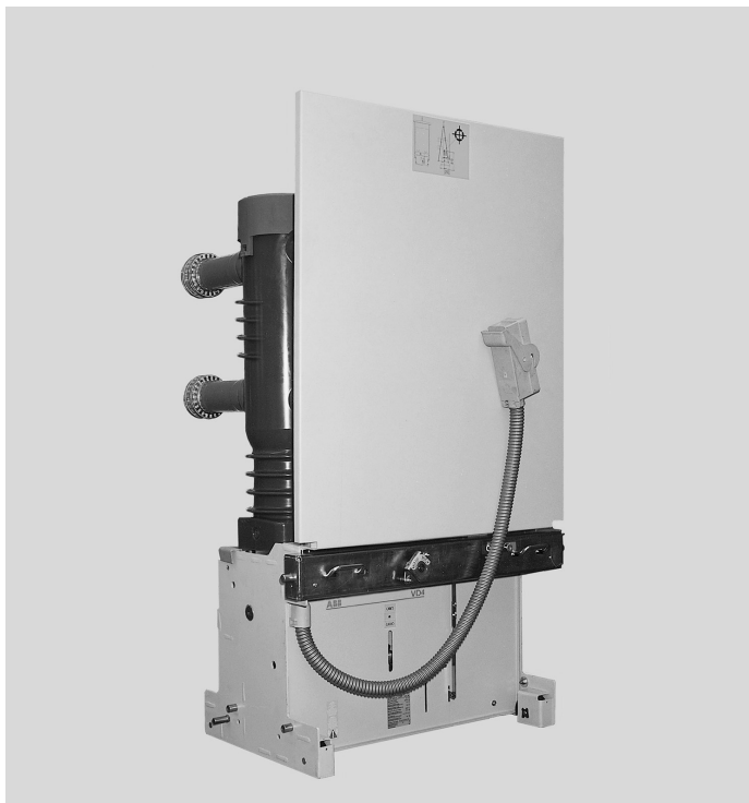
Fig. 3/7: Disjuntor a vácuo VD4 com partes dos polos montadas e ventilação forçada (ventilador), versão extraível, lado do comando 2500 A para utilizações a 55 °C 3150 A, 25/31,5 kA para utilizações a 40 °C
