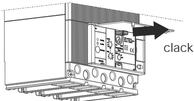
ATTENZIONE: Questa posizione di test è obbligatoria per effettuare il TEST di isolamento. Il TEST di sgancio del differenziale deve essere invece eseguito agendo sul pulsante TEST indicato in fig. Q.
