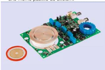
qui est tout à fait acceptable en cas de condensateur déchargé. La décharge génère en effet automatiquement le front descendant de l'impulsion de courant. Cet interrupteur permet d'injecter une énergie très élevée dans une charge (transformateur d'impulsion ou klystron) pour émettre les impulsions radar.
