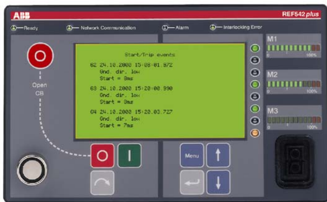
Affichage de la liste des événements sur l'écran LCD de l'interface HMI.
