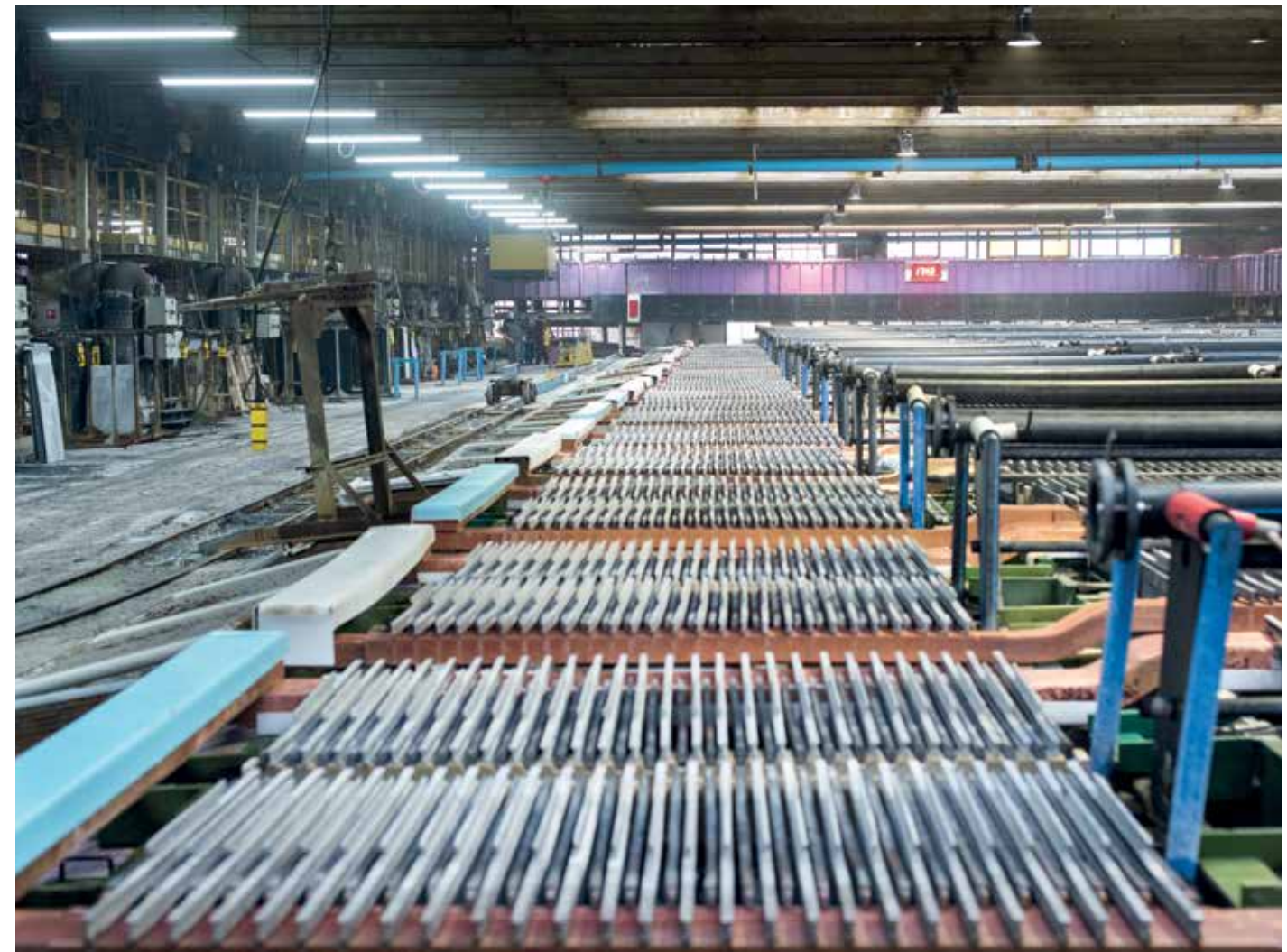
Hala Wanien, 44 kaskady po 12 wanien, przy czym każda z nich jest indywidualnie zasilana elektrolitem. W procesie elektrolizy na katodzie aluminiowej osadza się cynk katodowy.
