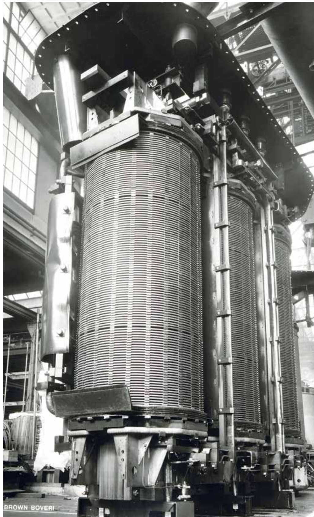
Trójfazowy, duży transformator mocy. Fabryka transformatorów Brown Boveri, Baden, Szwajcaria, 1942 rok.
