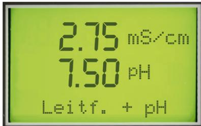
Gleichzeitige Leitfähigkeits- und pH-Messung
