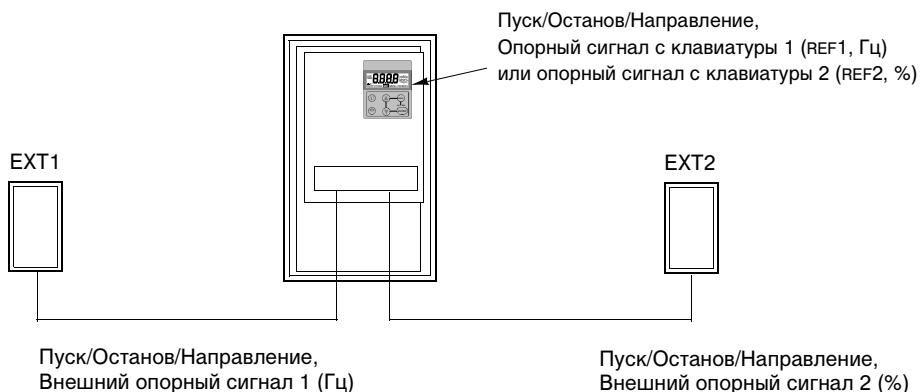
Рис. 1 Пункты управления и типы опорных сигналов.
