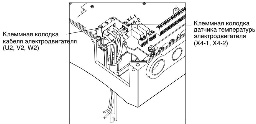
**Предупреждение.** При настенном монтаже использование датчика PTC электродвигателя не допускается, поскольку разъем X4 имеет потенциал главной цепи.
