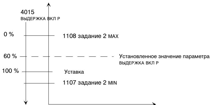
Рис.25 Пример смещения установленного значения уровня деактивации функции отключения; параметр 4015 WAKE-UP LEVEL равен 60 %, ПИД-управление с инверсией.
