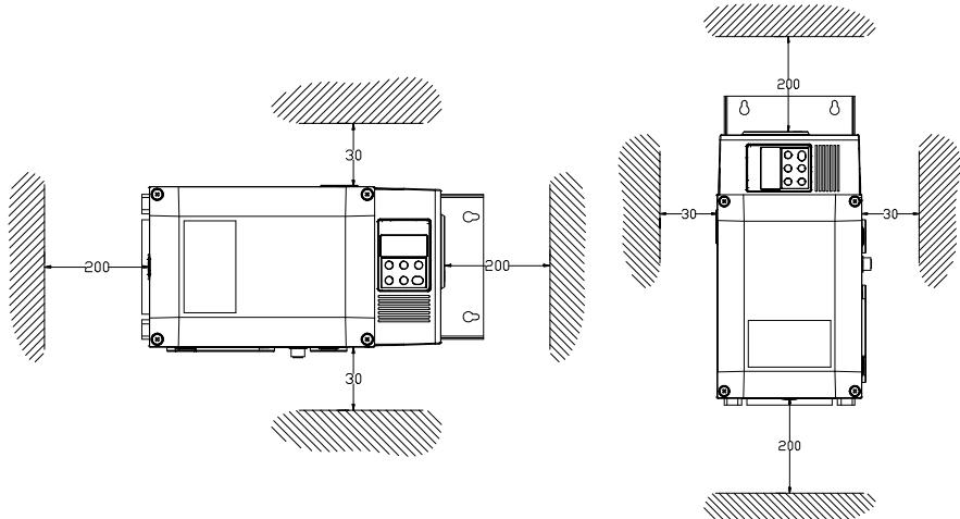
ACS 160 следует монтировать только на твердую поверхность.
