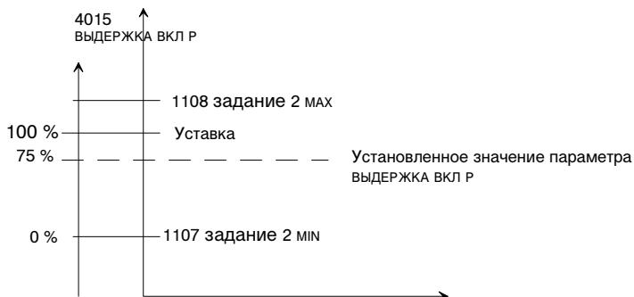
Рис.24 Пример смещения установленного значения уровня деактивации функции отключения; параметр 4015 WAKE-UP LEVEL равен 75 %, ПИД-управление без инверсии.
