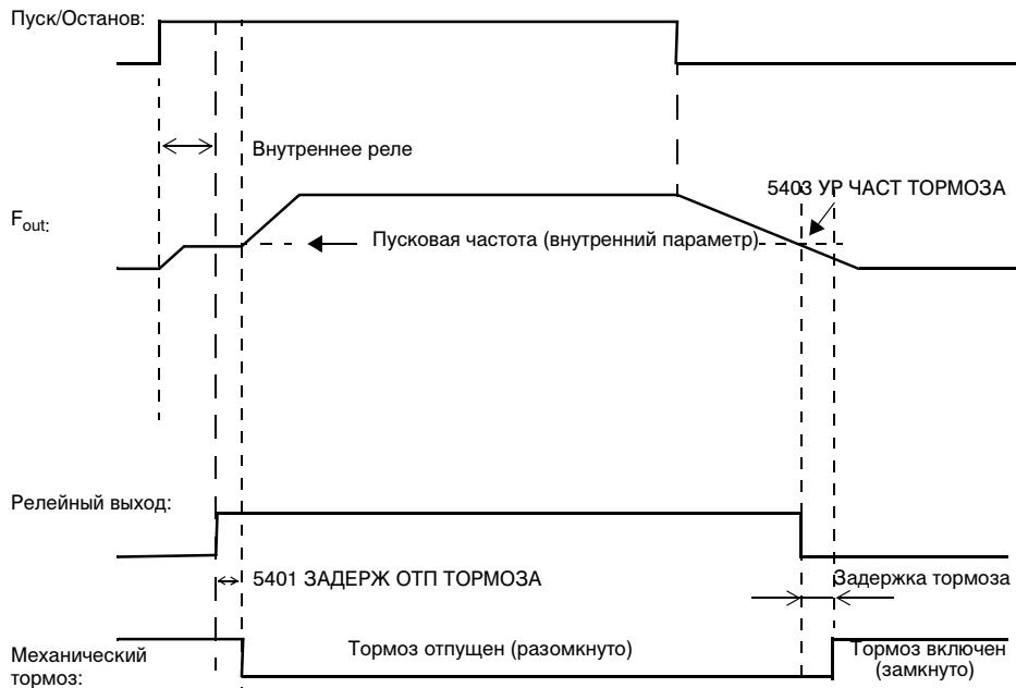
Рис.28 Работа контроллера механического тормоза.
