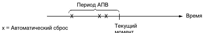
*Рис. 18 Работа функции автоматического повторного включения (сброса). В данном примере если неисправность происходит в момент «Текущий момент», то она немедленно сбрасывается при условии, что значение параметра 3101 КОЛ-ВО АПВ больше или равно 4.*
