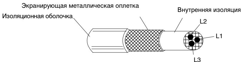
Рис. 34 Эффективное экранирование кабеля электродвигателя (например, кабели *ЦIflex-Servo-FD 780 CP*, *Lappkabel* или *MCCMK, NK*).
