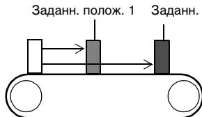
Рис. 2 Работа по умолчанию макропрограммы позиционирования, когда включено позиционирование.
