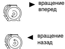
Поменяйте местами любые два провода кабеля электродвигателя на клеммной колодке преобразователя или в соединительной коробке электродвигателя.
