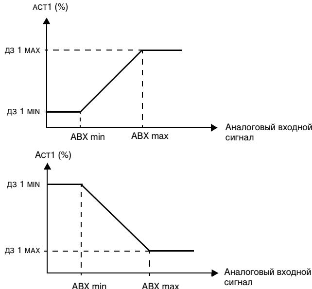
**Рис.22** Масштабирование действительного значения. Диапазон изменений аналогового входного сигнала устанавливается параметрами 1301 и 1302 или параметрами 1304 и 1305 - в зависимости от используемого аналогового входа.
