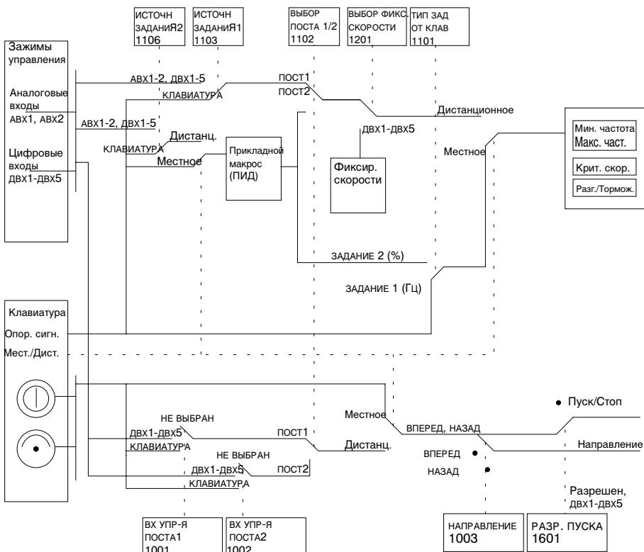
Рис. 29 Выбор пункта управления и источника опорного сигнала.
