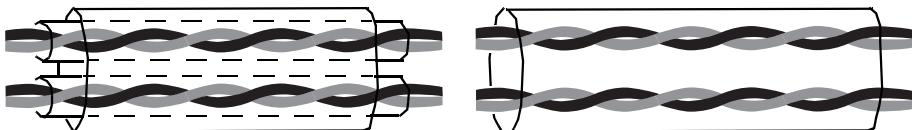
Рис. 35 Слева показан кабель со скрученными парами проводов и двойным экранированием, а справа – кабель со скрученными парами проводов и одним экраном.
