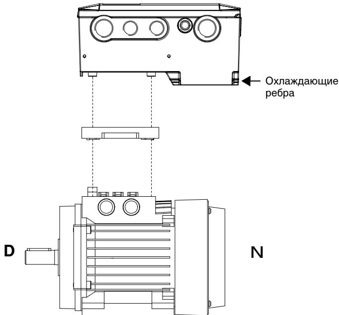
1. Соедините обмотки электродвигателя звездой или треугольником. См. табличку технических данных электродвигателя.
