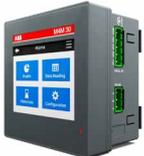
Baureihe M4M 30:<br>M4M 30 MODBUS Netzanalysegerät<br>mit 4 programmierbaren Ein-/Ausgängen,<br>Spannungsversorgung 48-240V AC/DC,<br>Bluetooth & Modbus RTU | 96 x 96 mm | M4M 30 MODBUS | 2CSG274761R4051 | 1           |
