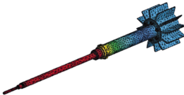
Distribution de la température du procédé : 80 °C (rouge) Température ambiante : 25 °C (bleu)
