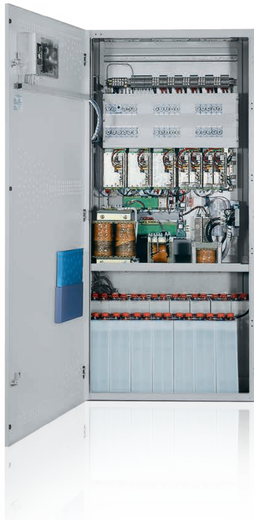
BSV OP Lux 850/5 mit NiCd-Batterie Nennleistung 850 W Überbrückungszeit 3 h
