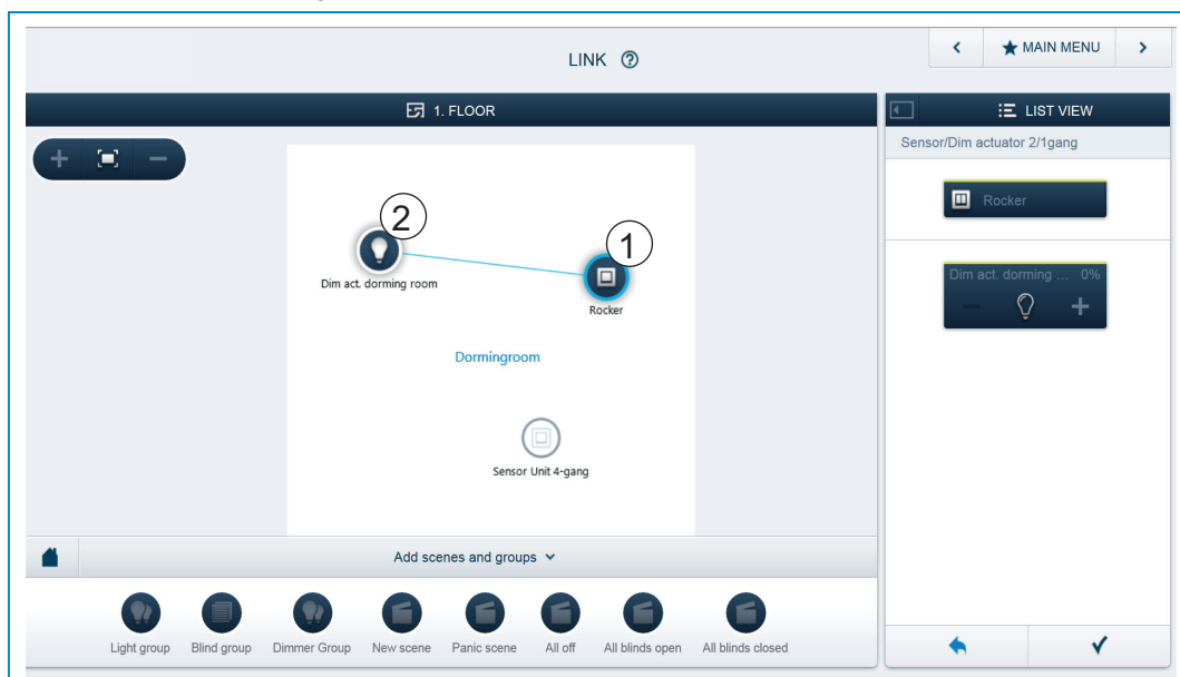
Fig. 13: Enlazar el actuador y el sensor
