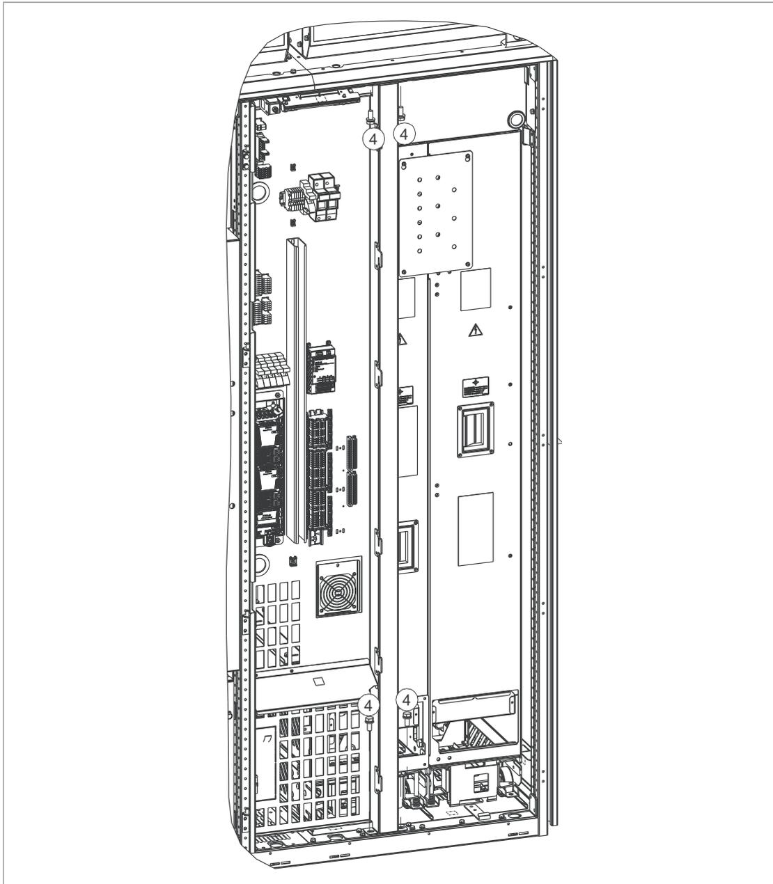
5. Desserrez les deux vis M6 du déflecteur d'air et poussez-le à gauche. (Pas pour les variateurs avec l'option +C128.)
