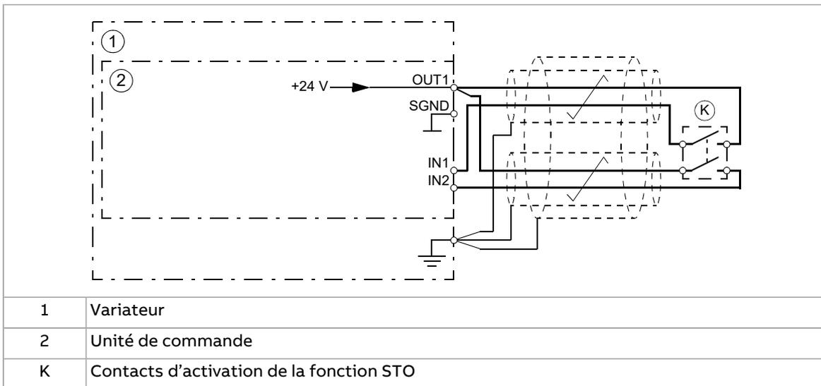
Raccordement sur deux voies de l'interrupteur (ZCU-14)
