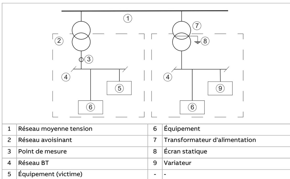
2. Un plan CEM de prévention des perturbations, dont vous trouverez un modèle dans le document anglais [Technical guide No. 3 EMC compliant installation and configuration for a power drive system \(3AFE61348280\)](#), a été mis au point pour l'installation.
