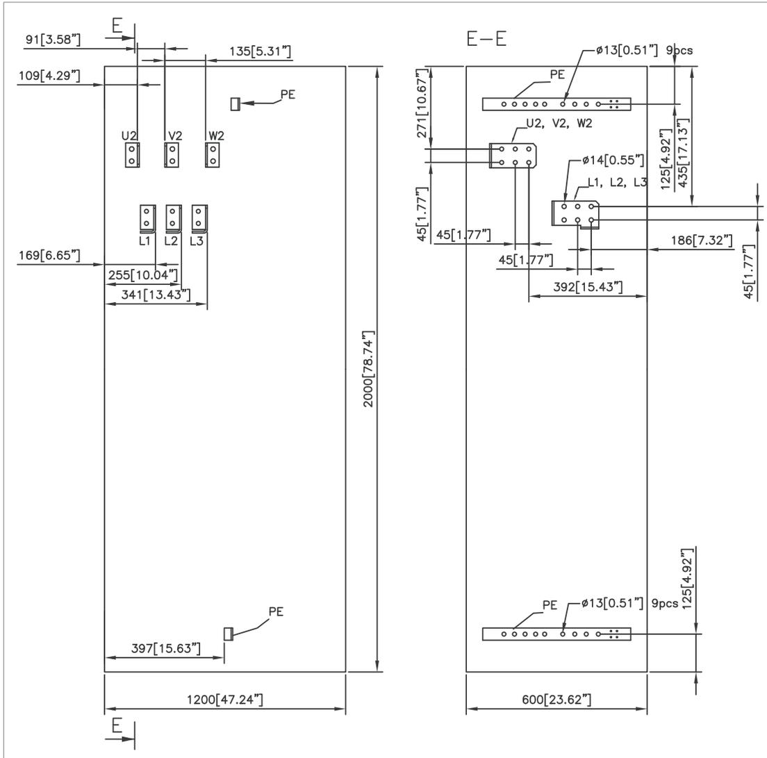
**Borniers de raccordement des résistances externes**
