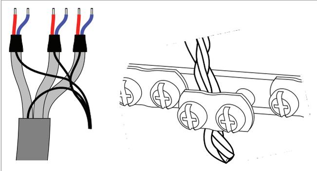
**N.B. :** À l'autre extrémité du câble, les blindages doivent être laissés non connectés ou être reliés à la terre indirectement par le biais d'un condensateur haute fréquence de quelques nanofarads (ex., 3,3 nF / 630 V). Les deux extrémités du blindage peuvent également être directement mises à la terre si elles sont sur la même maille de terre avec des extrémités équipotentielles.
