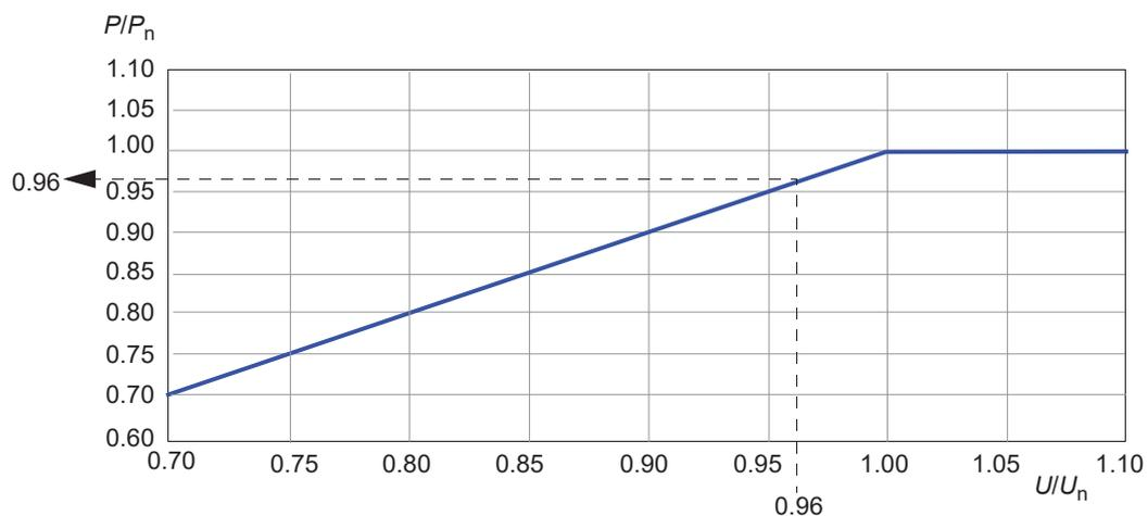
**Exemple 1 :**  $P_n$  pour ACS880-17-430A-7 est égale à 400 kW. La tension d'entrée ( $U$ ) est de 660 V.  $\rightarrow U/U_n = 660 \text{ V} / 690 \text{ V} = 0,96$ .  $\rightarrow P/P_n = 0,96$   $\rightarrow$  La puissance déclassée  $P = 0,96 \times 400 \text{ kW} = 384 \text{ kW}$ .
