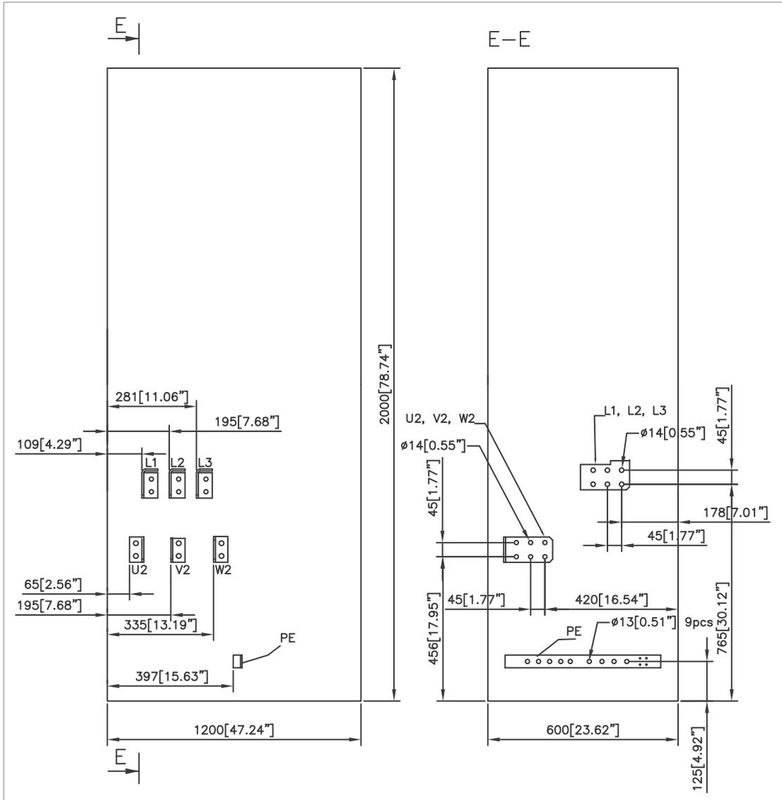
**Dimensions des bornes pour les câbles réseau et moteur R11 (entrée et sortie par le haut, options +H351 et +H353)**
