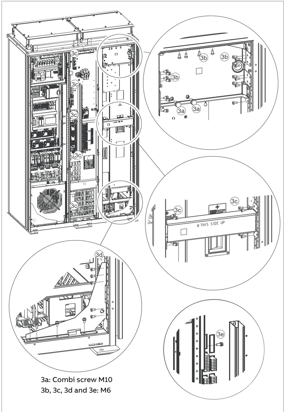
4. Pour ouvrir le rack pivotant des modules, retirez les écrous M10 en haut et en bas (4 en tout).
