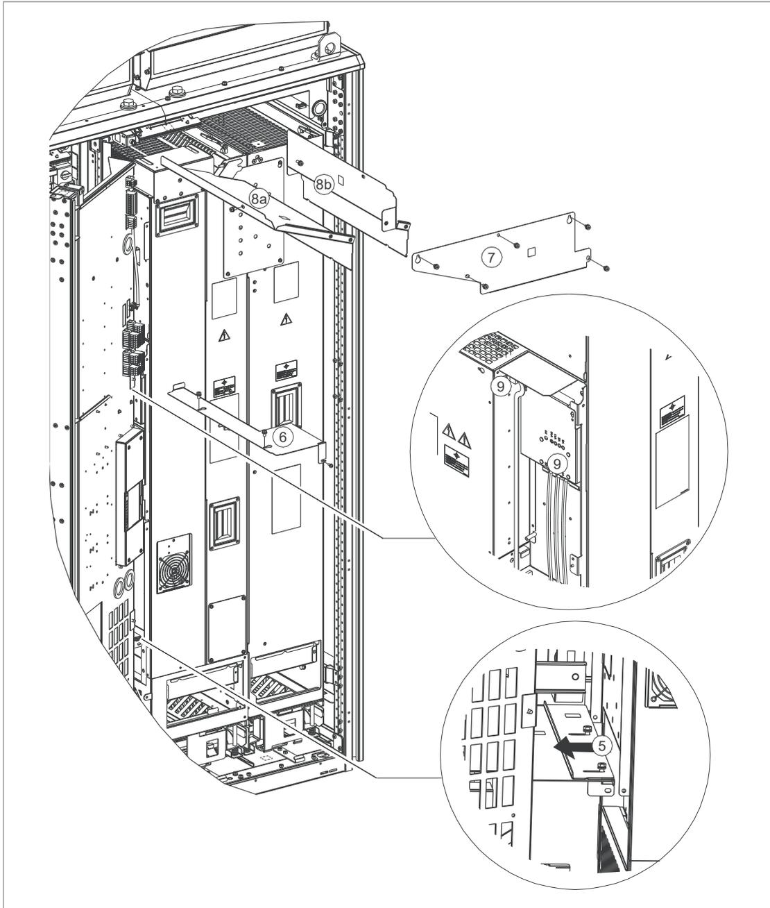
Le schéma suivant illustre les raccordements entre l'unité de commande du convertisseur réseau et le variateur. L'unité de commande du variateur reste à sa place lorsque vous retirez le module variateur.
