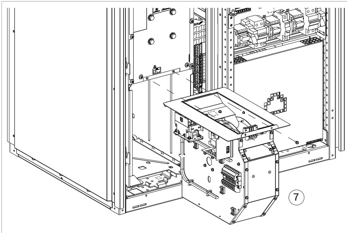
8. Retirez les deux vis M8 à l'arrière du module.
