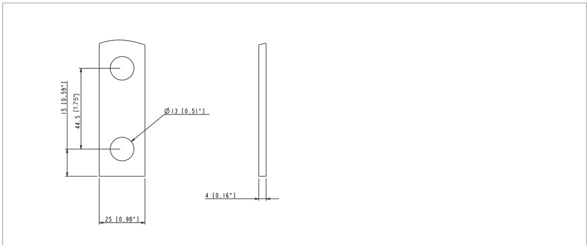
La distance entre les bornes adjacentes est de 25 mm (0.98 in) pour les variateurs sans l'option +E202 et de 50 mm (1.97 in) avec l'option +E202.
