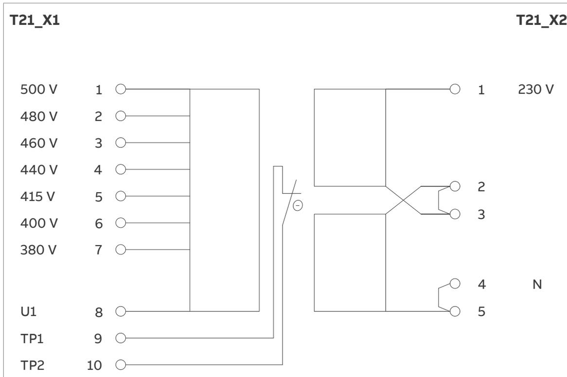
**Réglage des bornes des transformateurs T21 (690 V)**
