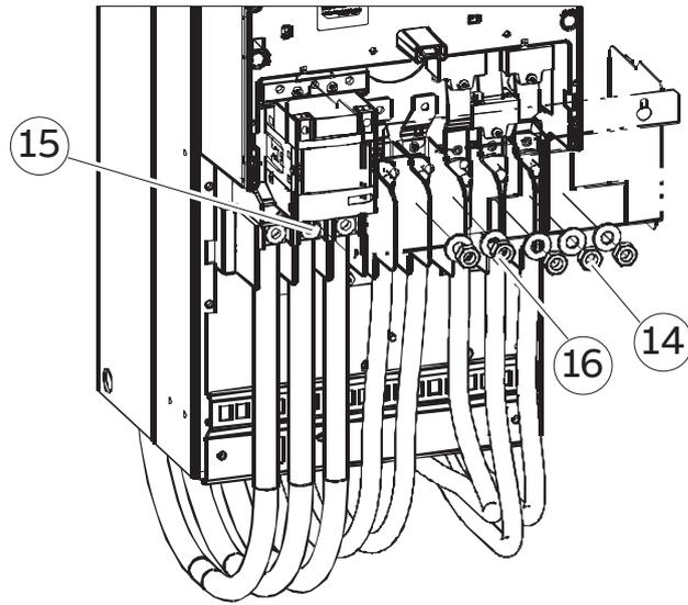
17. Desserrez les quatre vis universelles M6 et retirez la gaine de ventilation en plastique.
