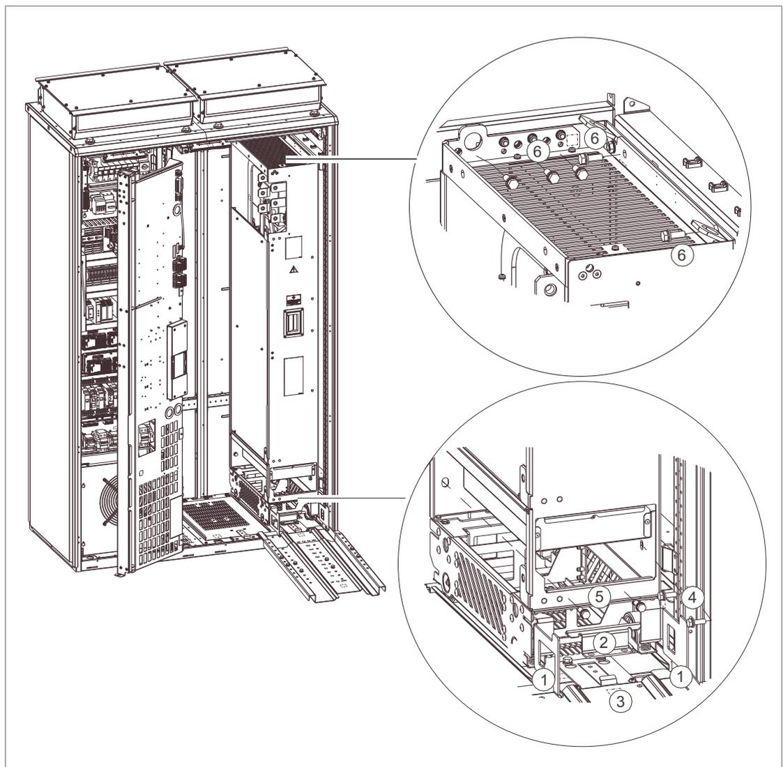
7. À l'aide de chaînes, fixez les anneaux de levage du module à retirer à ceux de l'armoire.
