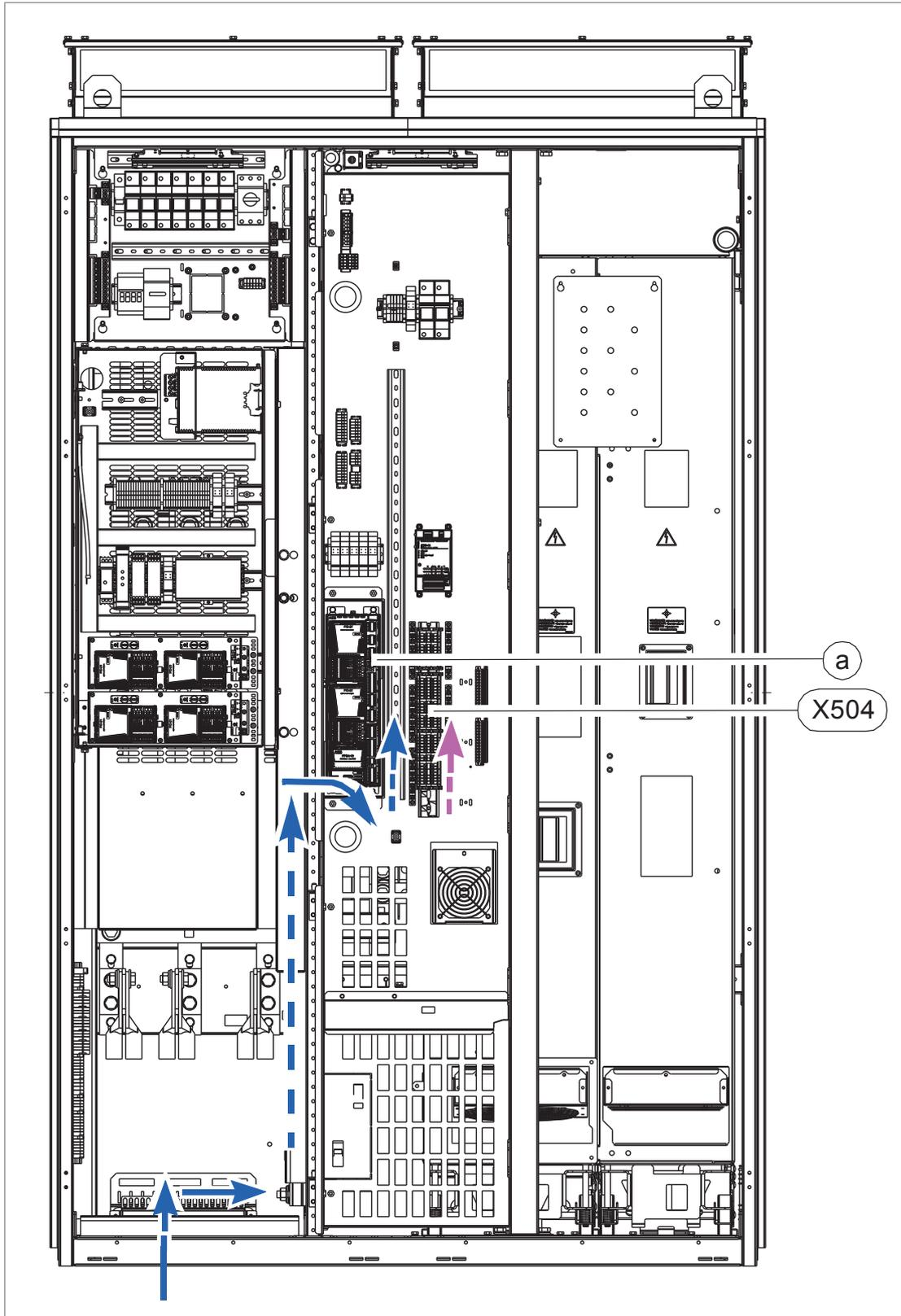
Entrée par le haut : faites cheminer les câbles de commande jusqu'à l'unité de commande (a) et jusqu'au bornier supplémentaire X504 (option +L504), comme
