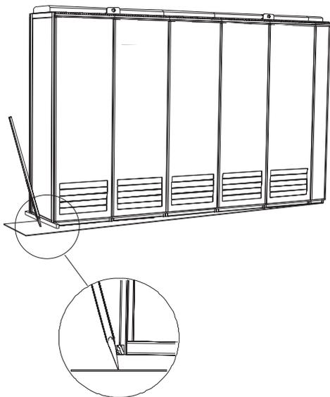
Utilisez une barre de fer (pieu) pour mettre l'armoire en position. Posez une cale en bois entre la barre et le coin de l'armoire pour éviter d'endommager le châssis.
