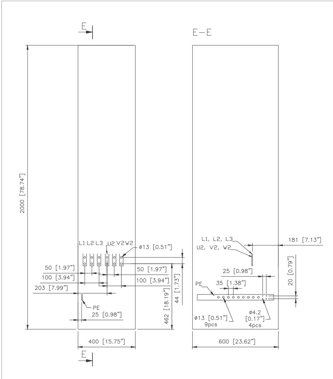
**Dimensions des bornes pour les câbles réseau et moteur R8 (entrée et sortie par le haut, options +H351 et +H353)**
