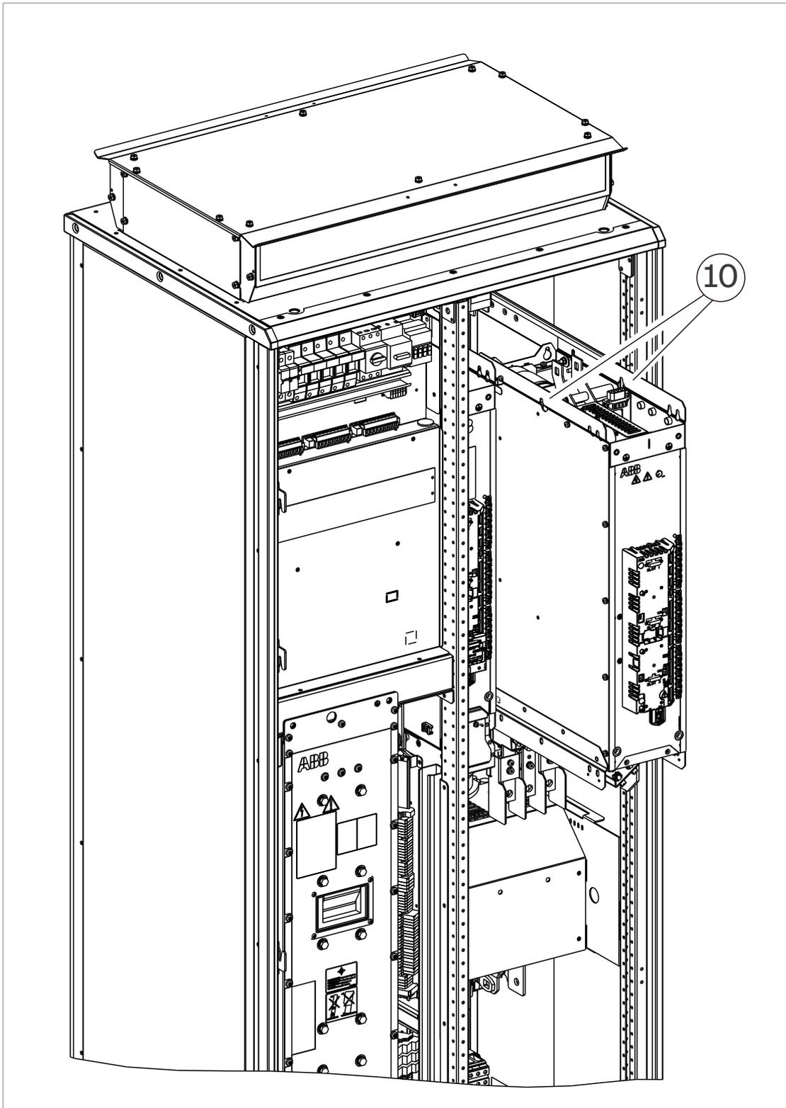
11. Accrochez les anneaux à un appareil de levage et sortez le module. Montez un module neuf en procédant dans l'ordre inverse.
