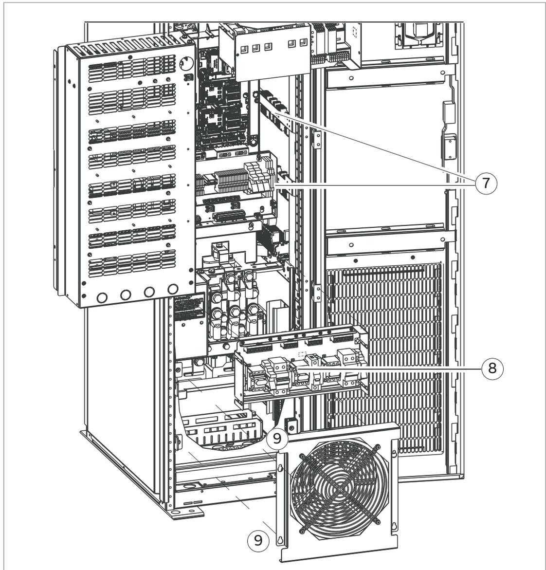
10. Desserrez les quatre vis M5 et retirez la protection en plastique.
