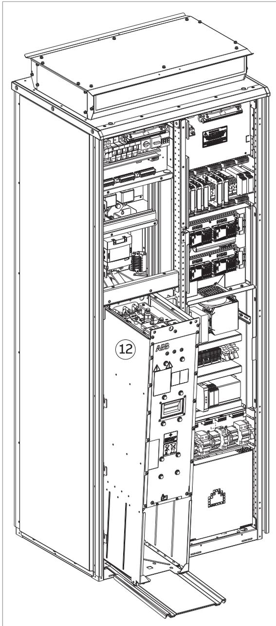
13. Montez le module neuf en procédant dans l'ordre inverse. Attention à vos doigts ! Maintenez une pression constante avec un pied sur la base du module pour l'empêcher de basculer sur l'arrière. Prenez garde à ne pas casser les vis de fixation : serrez les vis du module à 22 N·m (16.2 lbf·ft) et les boulons des jeux de barres c.a. à 42 N·m (31 lbf·ft). Branchez le faisceau de câbles sur le connecteur de signaux. Montez les protections.
