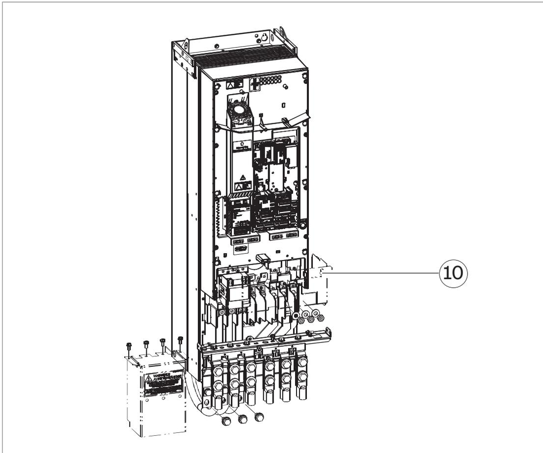
11. Variateurs avec entrée des câbles par le bas : desserrez les quatre vis universelles M6 et retirez la protection en plastique.
