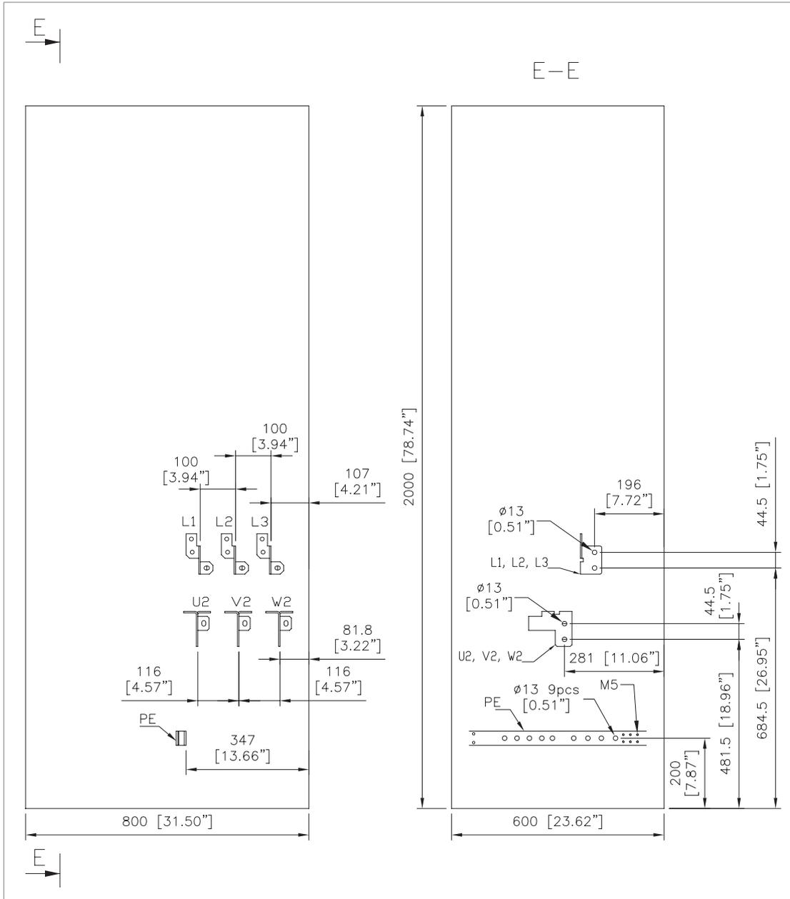
**Dimensions des bornes pour les câbles réseau et moteur R6i+R6i et R7i+R7i - entrée et sortie par le haut (options +H351 et +H353)**
