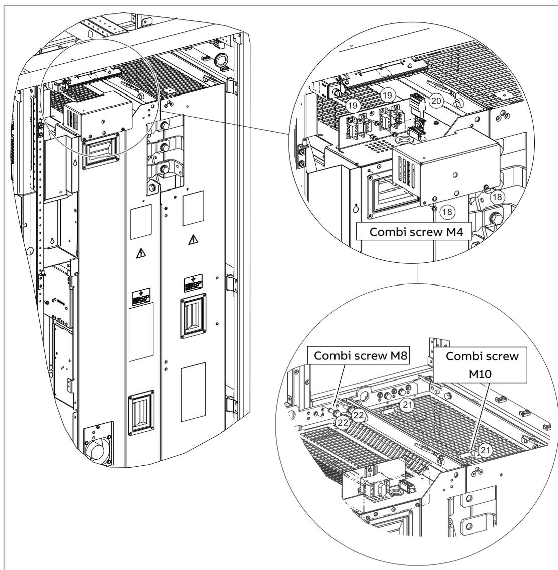
23. À l'aide de chaînes, fixez les anneaux de levage du module à retirer à ceux de l'armoire.
