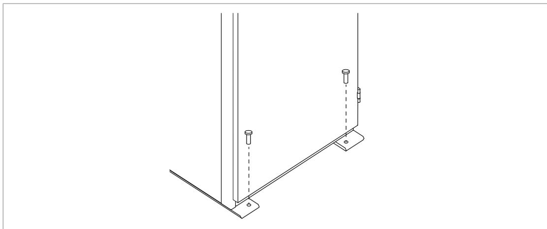
2. Si l'espace à l'arrière de l'armoire est insuffisant pour le montage, utilisez des colliers (a) pour fixer les extrémités arrière des fers plats (c) au sol. Cf. schémas ci-dessous.
