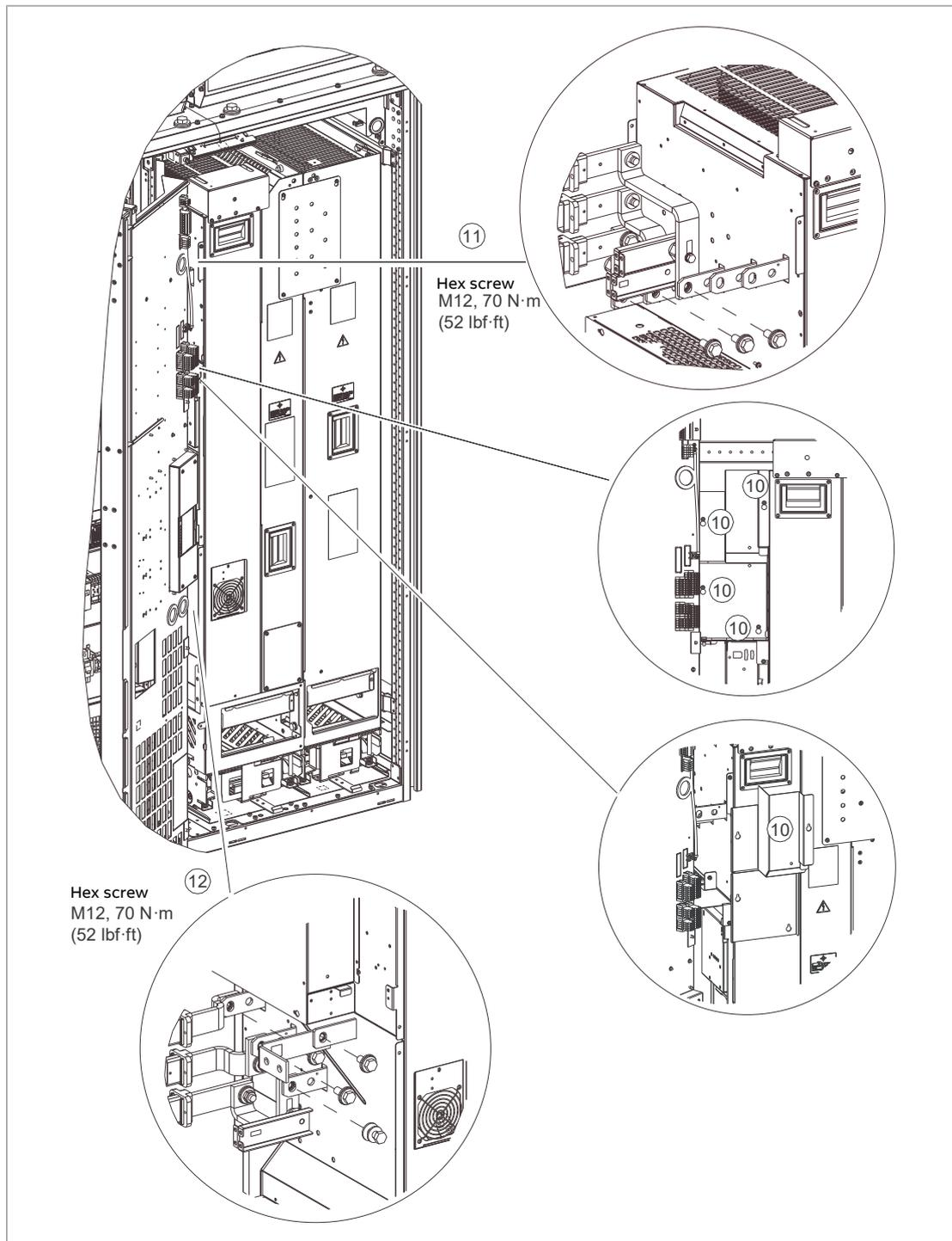
13. Sectionner le module variateur du module filtre LCL :
