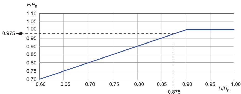
**Exemple 1 :**  $P_n$  pour ACS880-17-650A-3 est égale à 355 kW. La tension d'entrée ( $U$ ) est de 350 V.  $\rightarrow U/U_n = 350 \text{ V} / 400 \text{ V} = 0,875$ .  $\rightarrow P/P_n = 0,975$   $\rightarrow$  La puissance déclassée  $P = 0,975 \times 355 \text{ kW} = 346 \text{ kW}$ .
