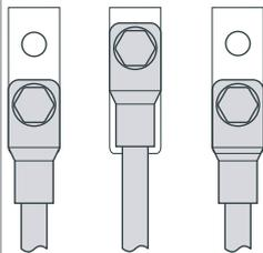
Diamètre maxi des cosses de câbles (y compris éventuelle gaine rétractable) pour la taille R8 : 38 mm (1.5 in) pour les variateurs sans l'option +E202 et 33 mm (1.3 in) pour les variateurs avec l'option +E202.
