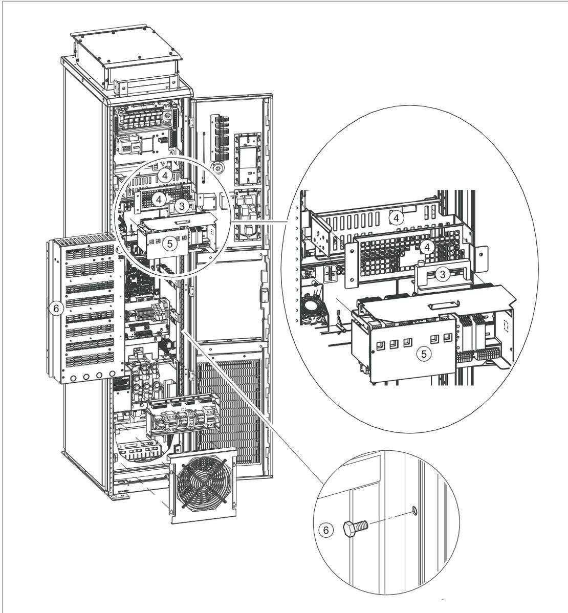
7. Déconnectez le câble de la microconsole du module et les bornes des câbles de commande sur le côté droit de l'armoire.
