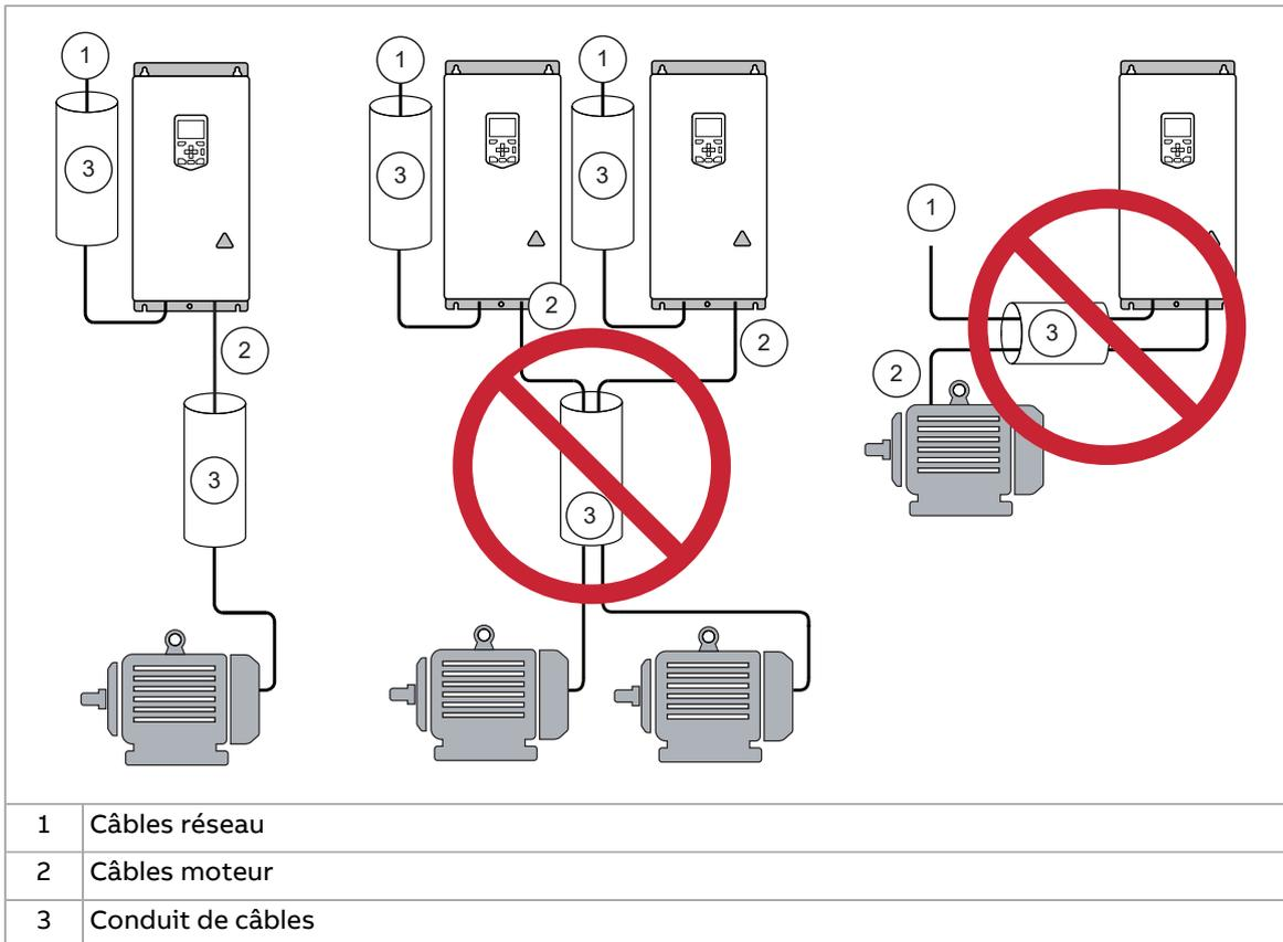
■ **Blindage/conduit continu du câble moteur et enveloppe métallique pour les dispositifs raccordés sur le câble moteur**
