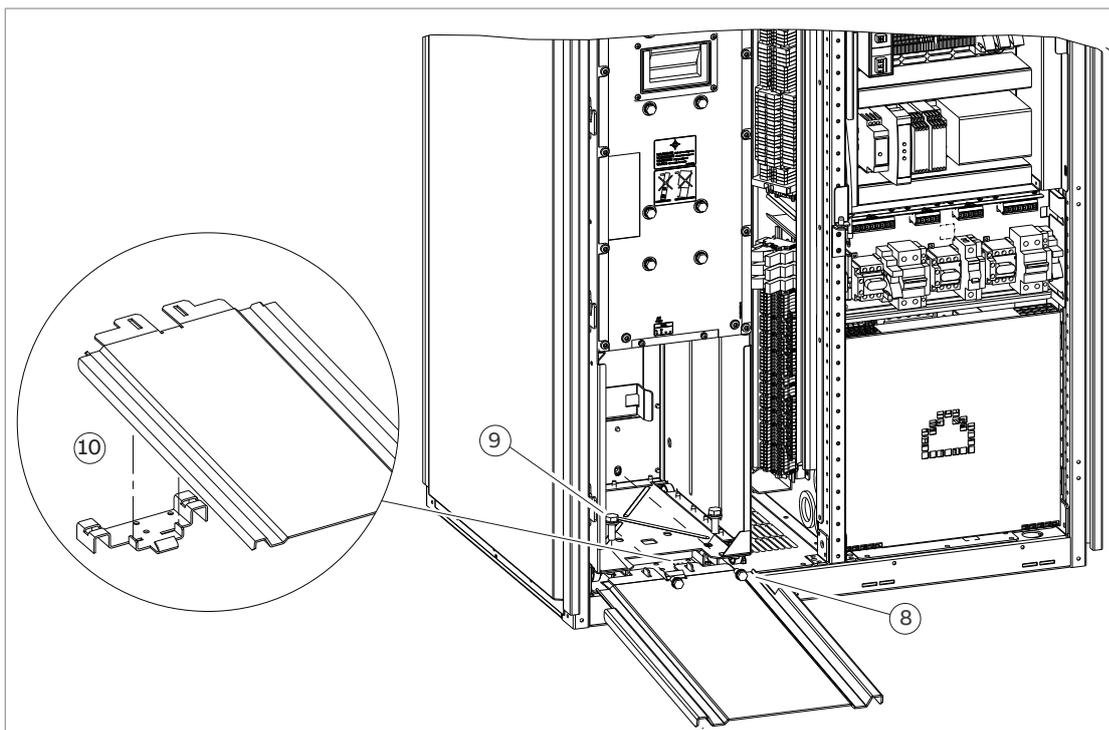
12. Faites délicatement glisser le module hors de l'armoire le long de la rampe. Lorsque vous tirez sur une poignée, maintenez une pression constante avec un pied sur la base du module pour l'empêcher de basculer sur l'arrière.
