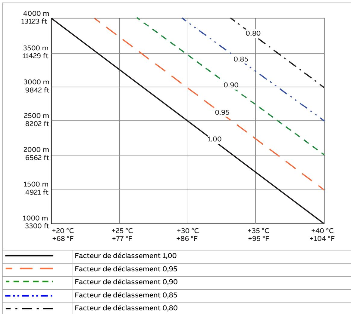
Pour calculer avec précision le déclassement, utilisez l'outil logiciel PC DriveSize.
