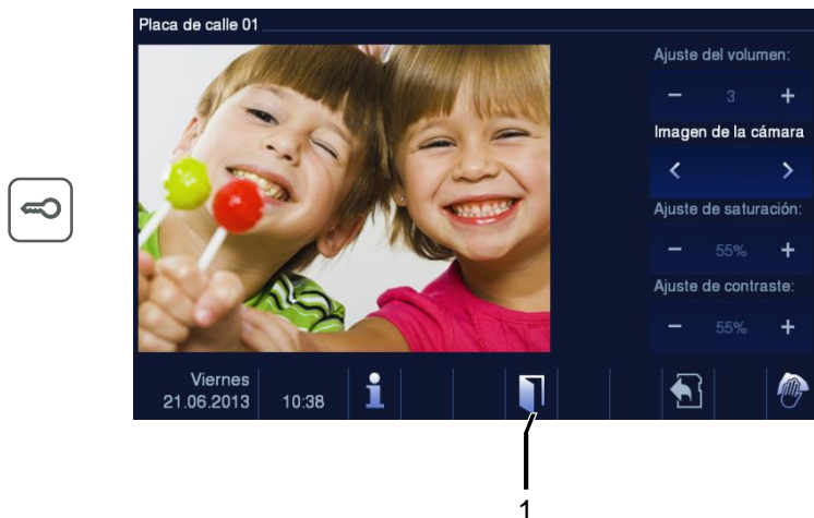
Fig. 8 Apertura de la puerta
