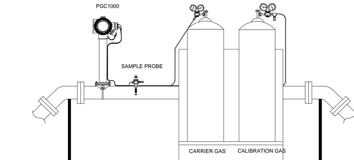
**Figure 2-1 Basic Meter Run Installation**
