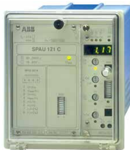
Trudne warunki środowiskowe i fizyczne, w jakich pracuje zabezpieczenie SPACOM, sprzyjają szybszemu starzeniu się układów elektroniki.
