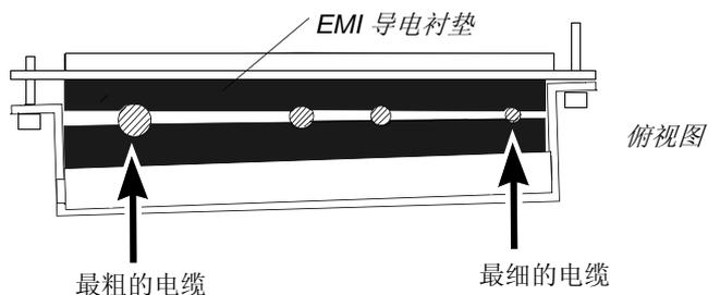
6. 如果有不止一条电缆穿过一个护套，护套必须用密封胶密封。
