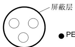
四芯电缆：三相导线芯和一个保护性导电芯。
