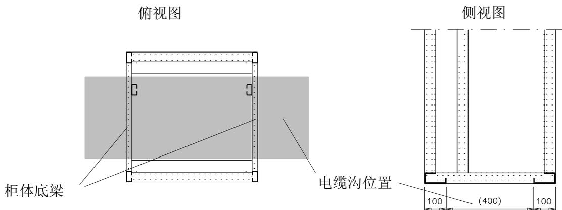
为防火、防电磁兼容性干扰和防止空气由电缆沟进入柜体。必须使用柜体本身发货时配备的底板覆盖在柜体底部。
