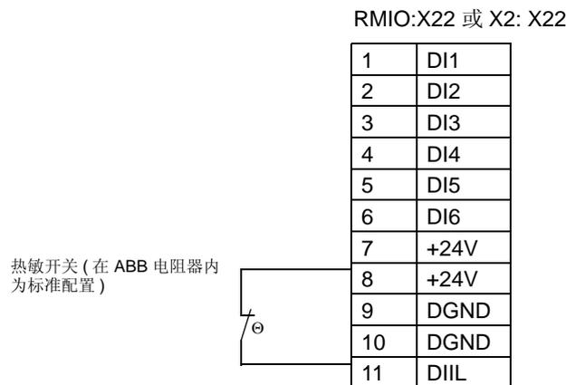
对于其他应用程序, 热敏开关可能被接到不同的数字输入口。可能需要将输入口通过程序设为 “EXTERNAL FAULT” 以实现传动跳闸。参见相关的 “固件手册”。
