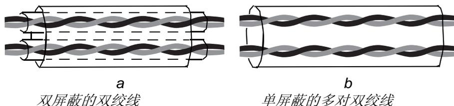
模拟信号和数字信号应使用单独的屏蔽电缆。
