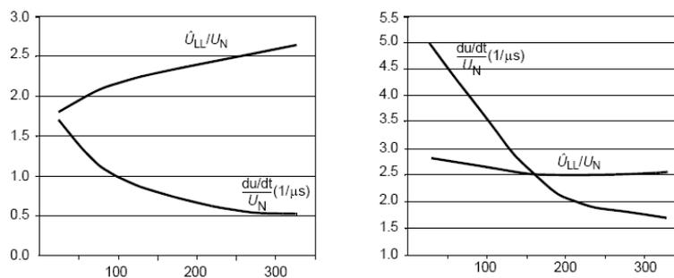
上图，横坐标为电缆长度，单位：米。纵坐标为倍数。左侧图带有 du/dt 情况，右侧图没有 du/dt 情况。
