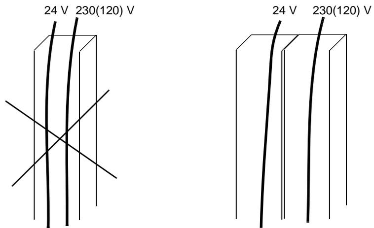
除非 24 V 电缆的绝缘能承受 230(120) V, 或者使用一个套管将 230(120)V 隔开, 否则不允许这样连接。
