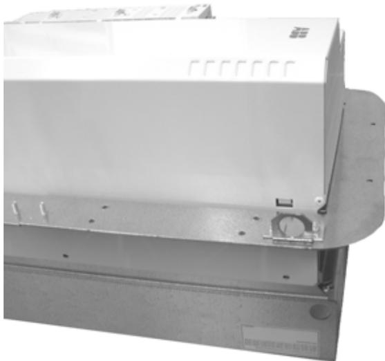
7. Fixez les supports latéraux au module variateur et aux attaches. Chaque support est fixé aux attaches par quatre écrous, et au module variateur par trois (des six) vis retirées à l'étape 3.
