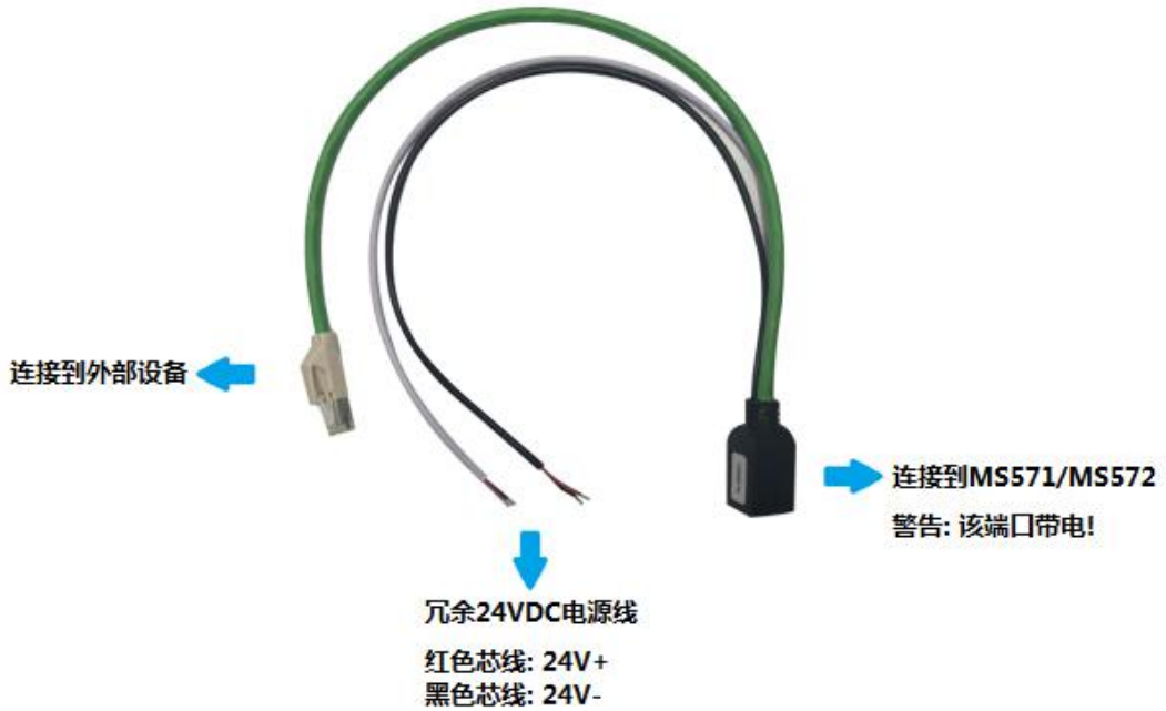
图 56-2 TA60 连接示意图
