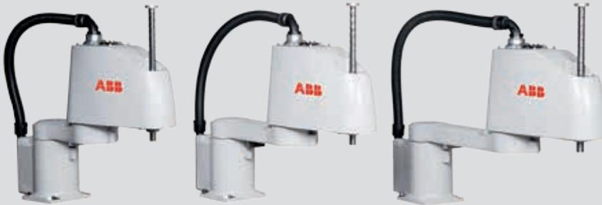
ABB a lancé sa toute première ligne d'automatismes SCARA (Selective Compliance Articulated Robot Arm), l'IRB 910SC, pour compléter sa gamme de robots industriels. Vitesse, précision et rentabilité sont les points forts de cette nouvelle famille de petits automates.
