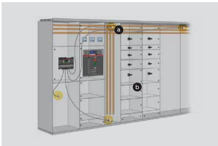
02 a Jeux de barres horizontaux/verticaux b Armoire du disjoncteur
