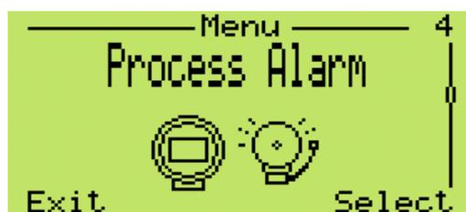
Ce menu permet de régler l'alarme de procédé. La structure du menu guidera l'utilisateur dans la sélection des fonctions de sécurité intégrée telles que les limites de saturation et le niveau de déclenchement du mode erreur (haut et bas).
