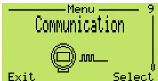
Cette dernière section du menu structuré donne la possibilité de modifier le numéro d'identification et le numéro d'adresse Hart "burst mode" de l'appareil.
