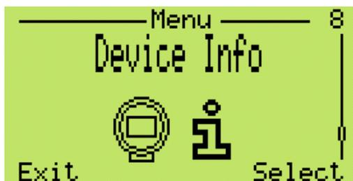
Ce menu donne des informations sur l'appareil. La structure du menu indiquera le type du capteur, les révisions du logiciel et du matériel, les limites hautes et basses du capteur ainsi que la plage de mesure minimum applicable.
