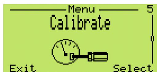
Ce menu permet d'étalonner l'instrument localement. La structure du menu guidera l'utilisateur dans le choix de la limite de coupure du capteur de pression (basse ou haute) et du paramétrage de la sortie (fixé à 4 ou à 20 mA). A la fin, il sera possible de rétablir ces paramètres (aux paramètres usine pour la coupure du capteur, aux paramètres utilisateur pour la coupure du capteur ou aux paramètres usine pour la coupure de la sortie).
