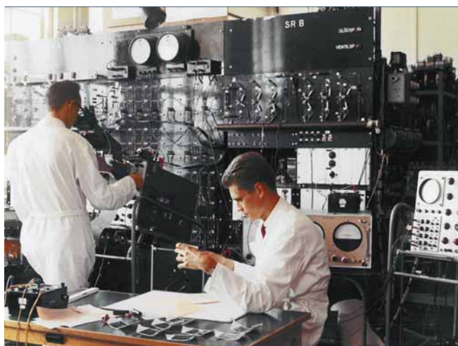
Simulateur analogique utilisé pour la conception des premiers systèmes de transport CCHT
