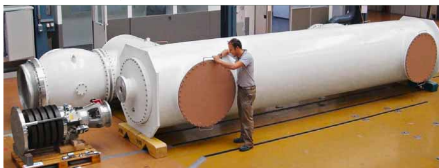
3 Disjoncteur à isolation gazeuse ABB avec sa commande en cours d'assemblage en usine
