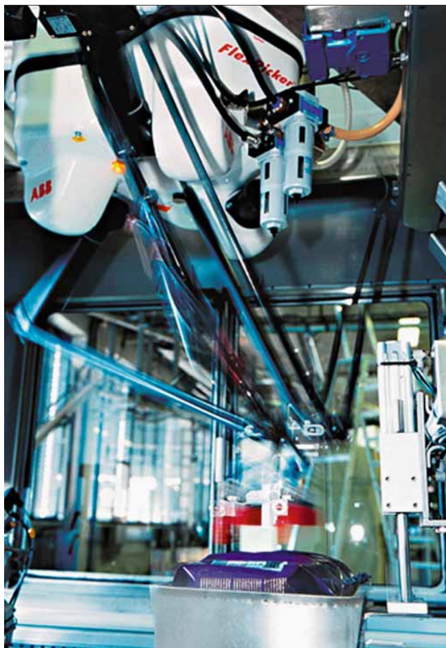
5 IRB 340 conditionnant des paquets de café chez le Suédois Löffbergs Lila
