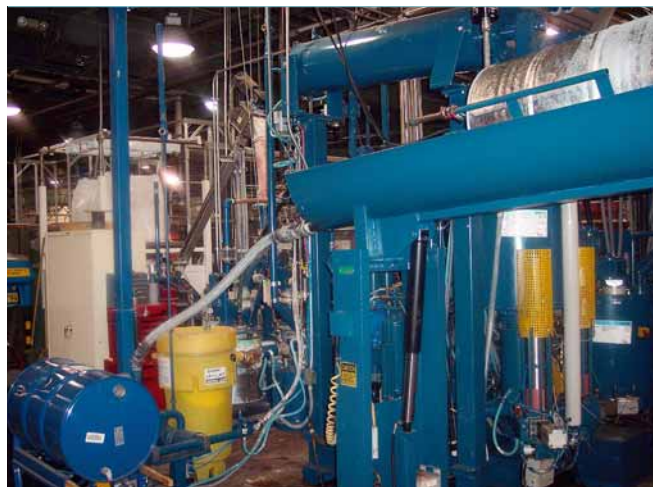
6 Equipement de mélange de l'époxyde dans l'usine ABB de Pinetops en Caroline du Nord (Etats-Unis)
