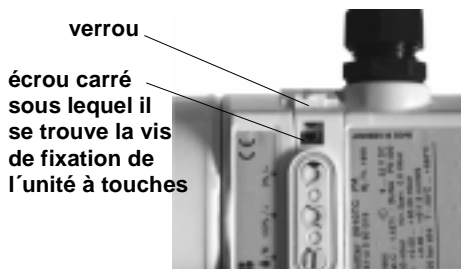
Figure 8. Unité à touches-Démontage / montage
