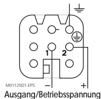
Crimpschluß für 0,75...1,0mm 2 -Leiter (auch lötlbar) Bild 10. Anschlußplan für den Steckdoseneinsatz
