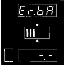
Bei zu geringer Batteriespannung wird innerhalb von 4 Sekunden für 2 s die Meldung „Er.bA“ eingeblendet. Das Gerät bleibt funktionsfähig.
