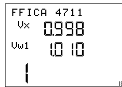
Bild 3-6 Anzeige Vx = Vist und Vw1, Vw1 ist einstellbar z-19018
