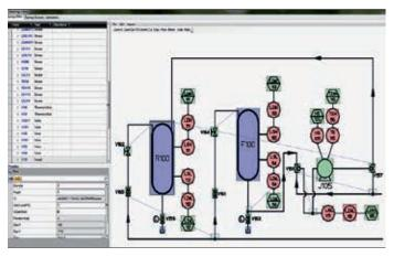
En première colonne et en première ligne de la matrice  $\rightarrow$  8 figure la liste des éléments reconnus, répertoriés et nommés (cuve E100, etc.). Les données saisies à l'intersection ligne-colonne représentent les liaisons entre éléments, repérées par une lettre: F pour flux matières, I pour flux d'informations.
