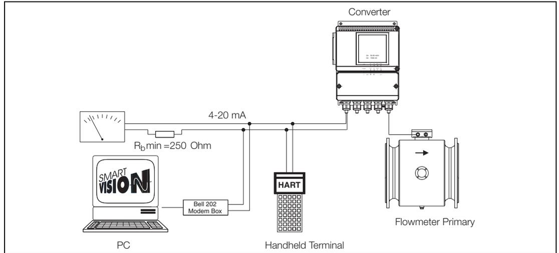
Fig. 66: Communication using HART-Protocol
