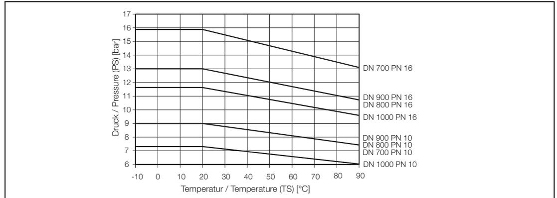
Fig. 51: DIN-Flanges Steel DN 700 – DN 1000
