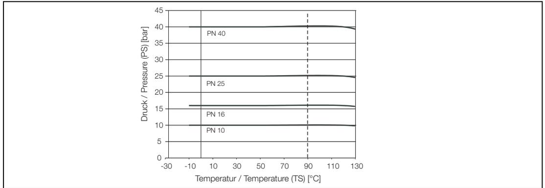
Fig. 48: DIN-Flanges Steel to DN 600[24"]
