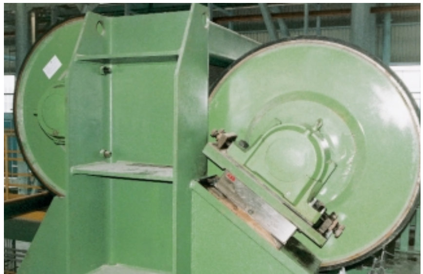
Jauge de contrainte pour la mesure directe de traction de bande, montée sur la tensionneuse en entrée de la section de traitement 3
