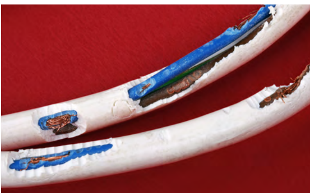
Abbildung 11: Mögliche Ursachen für serielle Fehlerlichtbögen
