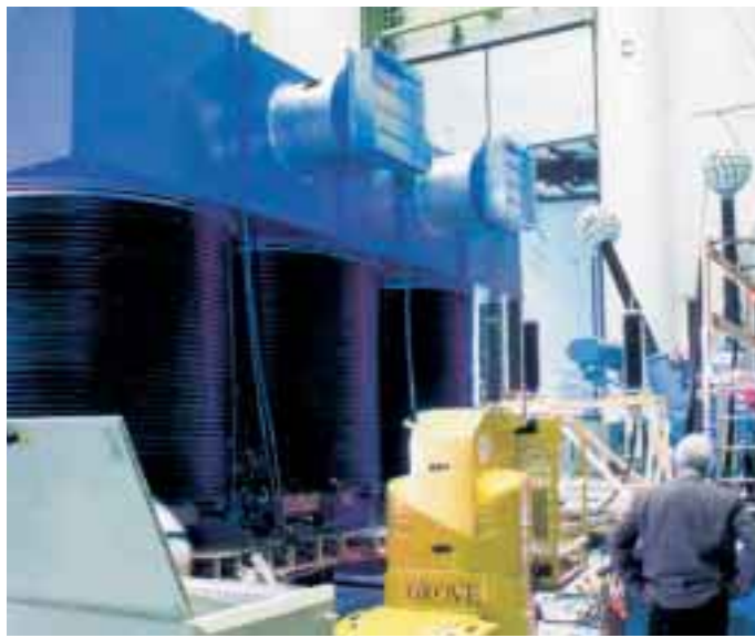
Kraftig isolering är typiskt för ABB:s nya kabellindade transformatorer.
