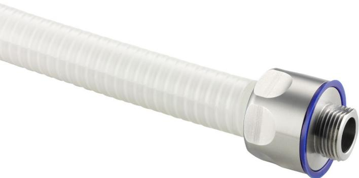
テクノロジーパートナーのBioCoteと共同開発した私たちのソリューションは、新世代のリキッドタイト防水コンジットチューブに抗菌保護機能を統合しています。FDA、EC、およびFSA認証に準拠したDuPont Hy-trel®スムーズサーモジャケットを特長とするコンジットチューブは、316ステンレス製の一体型リキッドタイト防水フィッティングによって補完されます。新しいシステムは、他のタイプのコンジットシステムの実行可能な代替手段となり、処理装置と周囲のプロセス領域の保護に完全に適しています。
