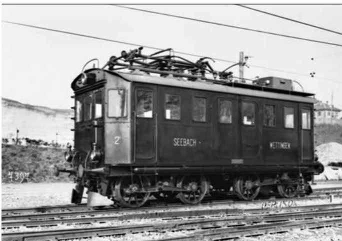
4 MFO-Versuchslok Nr. 2 mit Einphasen-Antriebsmotoren
