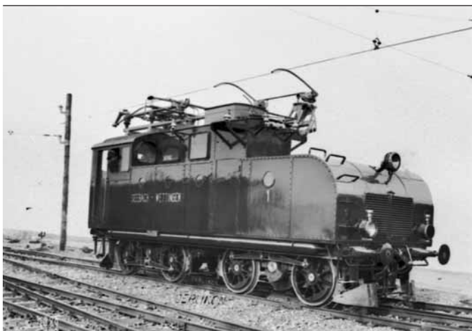
3 MFO-Versuchslok Nr. 1 mit rotierendem Umformer und Gleichstrom-Antriebsmotoren
