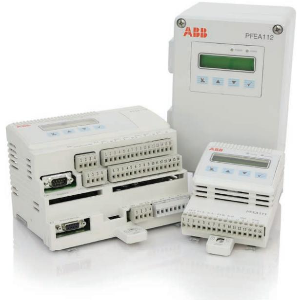
Pressductor®張力計専用アンプ：PFEA シリーズの基本的な役割は、Pressductor®張力計センサーに 330Hz の励磁電流を供給すること、そして、センサーで発生した測定信号を処理することです。
