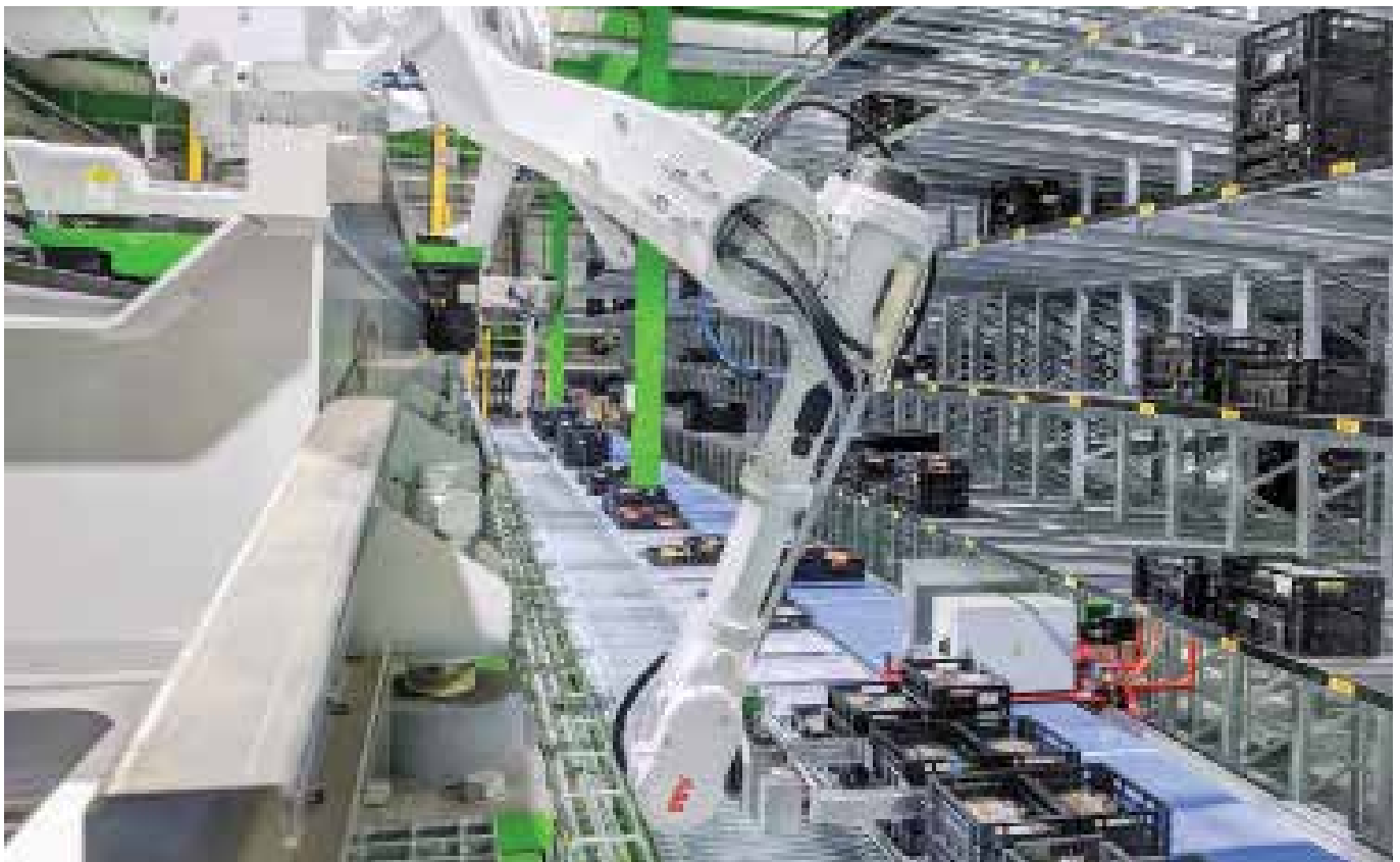
Uma instalação robótica de coleta de pedidos nas instalações da Heemskerk em Rjinsburg, na Holanda, prepara os pedidos de acordo com as necessidades de cada supermercado ou varejista de alimentos, para que os produtos possam ser transferidos diretamente para as prateleiras dos supermercados em vez de serem armazenados nos centros de distribuição.
