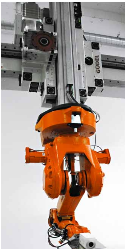
6 Robot ABB sur portique équipé d'une caméra pour des tâches d'inspection
