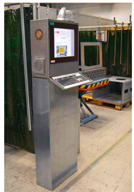
1 Poste opérateur à écran tactile, clavier et lecteur de codes à barres sans fil
