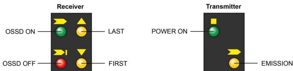
La signification des voyants sur le récepteur (RX) dépend du mode de fonctionnement de l'AOPD.
