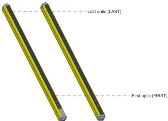
El proceso de alineación debe realizarse tras haber completado la instalación mecánica y las conexiones eléctricas.
