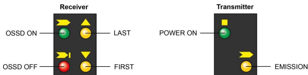
Die Bedeutung der LEDs am Empfänger (RX) hängt von dem AOPD-Betriebszustand ab.
