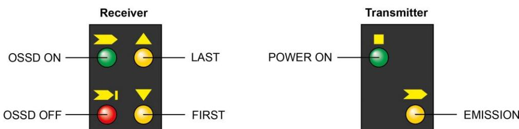
Il significato dei LED sul ricevitore (RX) dipende dalla modalità di funzionamento dell'AOPD.
