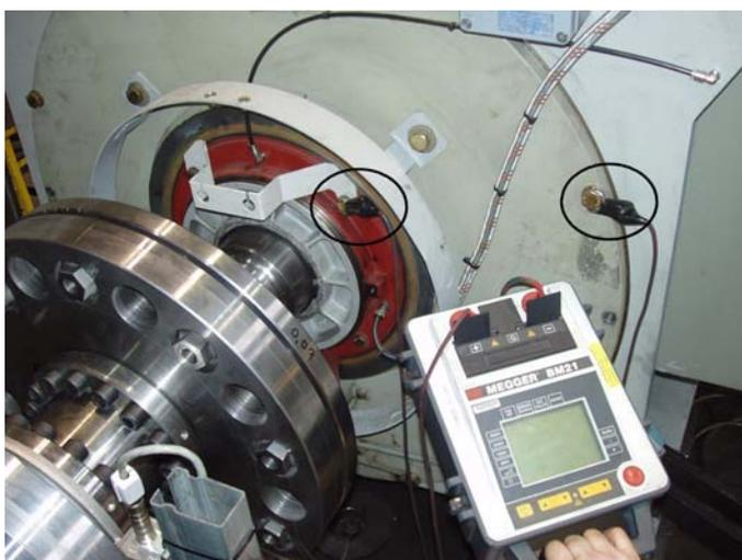
*Figure 7-4 Mesure de la résistance d'isolation d'un palier à roulement*
