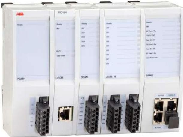
Los Módulos Riel Din RIO600 ayudan a expandir el número de entradas y salidas digitales de IEDs. Cuenta con módulos dedicados para entradas mA, RTD, salidas mA, recepción de sensores combinados de corriente y tensión para detección de fallas, así como salidas de potencia para control y disparos.
